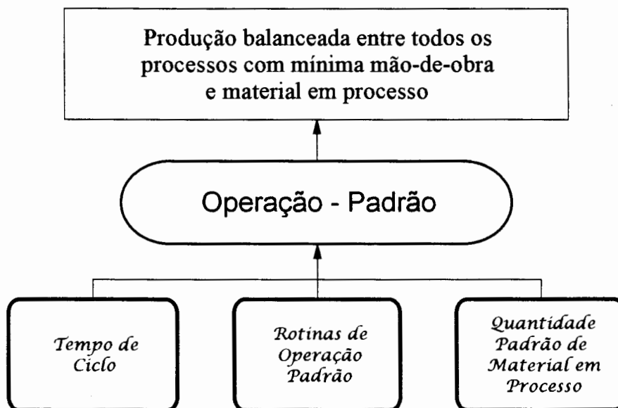
Figura 3.18 - Elementos da operação padrão.
