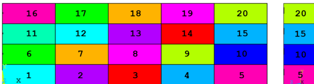
Figura 62 – Malha de elementos finitos para modelagem numérica das vigas de Bresler e Scordelis (1963)
