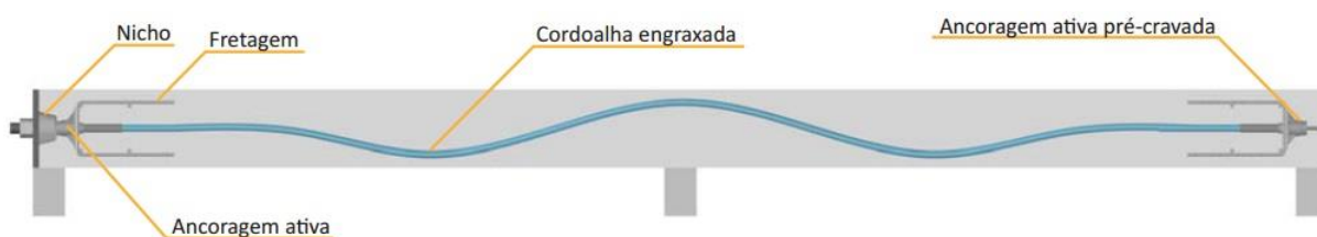
Figura 8 – Representação esquemática de um cabo de monocordoalha engraxada em corte longitudinal
