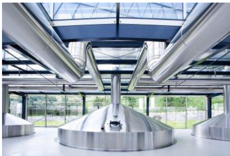
Figura 2.3 Tina de mostura ou Mosturador de uma cervejaria. Fonte: ( http://www.engenharia-brasil.com )
