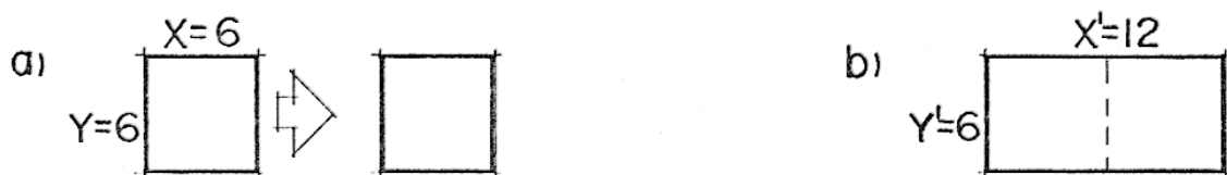
Fig. 41 - Edifícios com igual área e 6m de lado. ( 2 \times 6\text{m} \times 6\text{m} = 1 \times 6\text{m} \times 12\text{m} )
