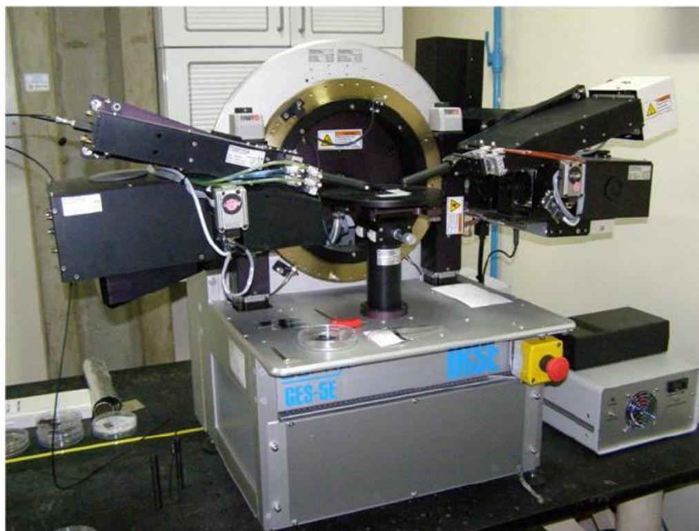
Figura 12: Elipsômetro SOPRA do Laboratório de Laser da UFRGS.
