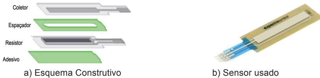
**Figura 4.1-** Potenciômetro utilizado para obtenção da posição do atuador. (Spectra Symbol, “Membrane Potentiometer Datasheet”, 2015)
