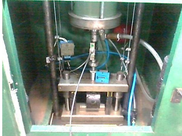
Figura 18: Apresentação do equipamento de fadiga por compressão diametral com o pórtico.
