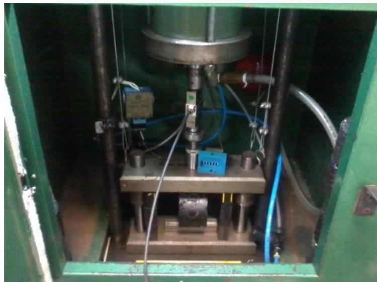
Figura 2: Equipamento para ensaios de fadiga em amostra diametral
