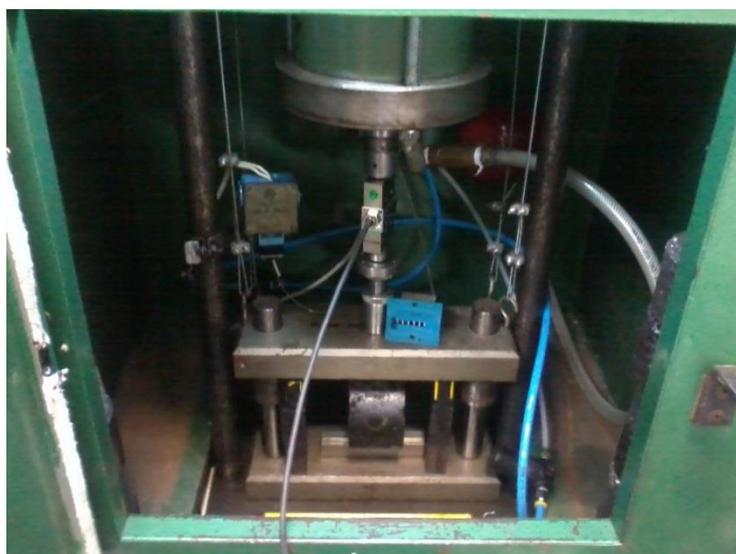
Figura 5: Equipamento para ensaio de fadiga por tração indireta
