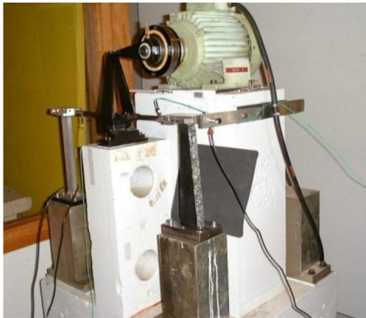
Figura 1: Equipamento para ensaio de fadiga em amostra trapezoidal
