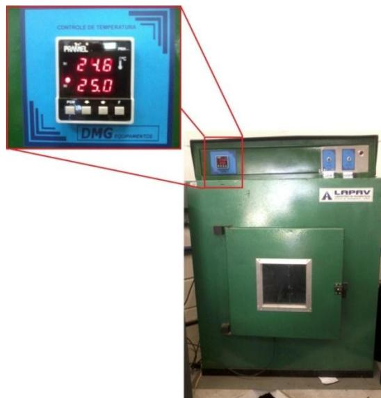
Figura 19: Apresentação do equipamento de fadiga por compressão diametral com câmara termo-regulável.
