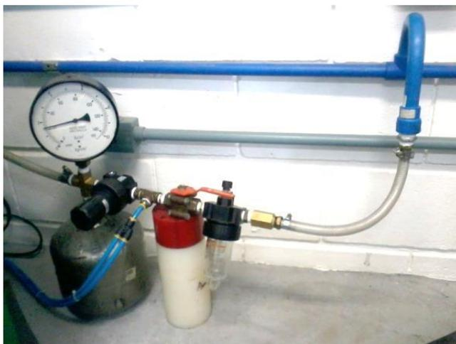
Figura 17: Apresentação do equipamento de fadiga por compressão diametral, com o sistema de controle da pressão do ar.
