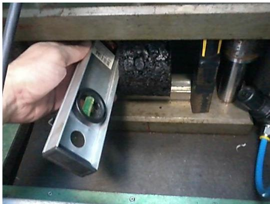
Figura 21: Passo-a-passo da montagem do ensaio com nivelamento do CP
