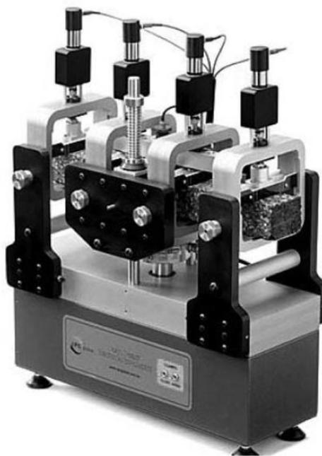
Figura 3: Equipamento para ensaios de fadiga em vigota (configuração quatro pontos)
