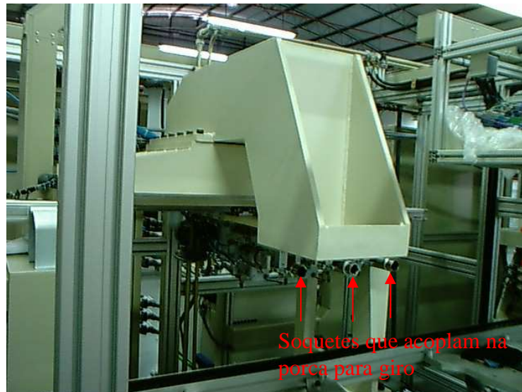
Figura 3.33 – Foto do posto 75 onde é possível visualizar os soquetes de giro.
