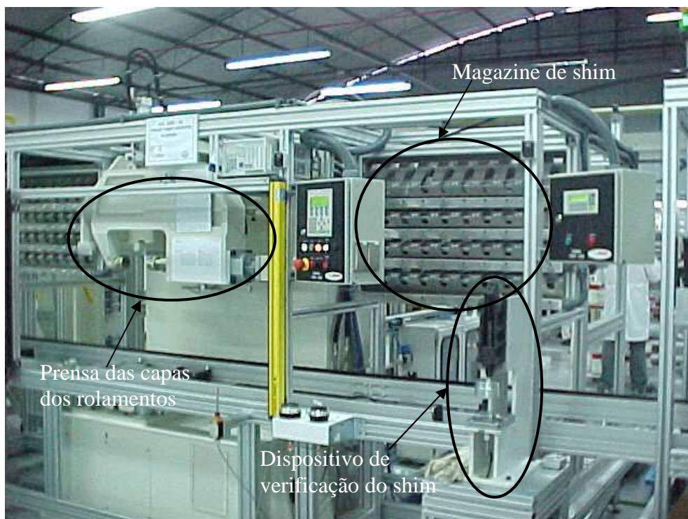
Figura 3.26- Posto 50 com a prensa, o magazine e o dispositivo verificador.
