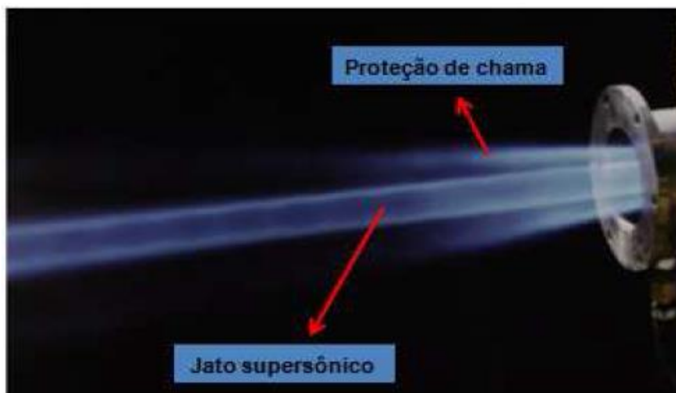
Figura 2.20: jato supersônico com chama de proteção.
