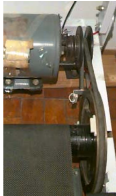
Figura 5.6 - Conjunto motor, polia variadora e sistema de tração da cinta.
