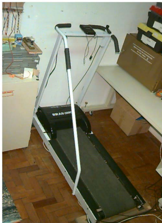
Figura 5.4 – Foto da esteira ergométrica instrumentada com plataformas de força.
