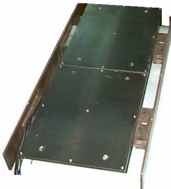
Figura 5.2 - Montagem das plataformas de força
