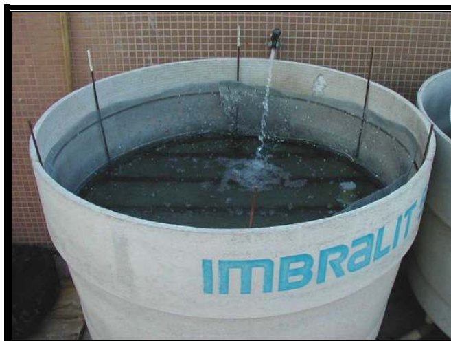
Figura 4.8: Tanque de lavagem e cesta para coleta do material decantado
