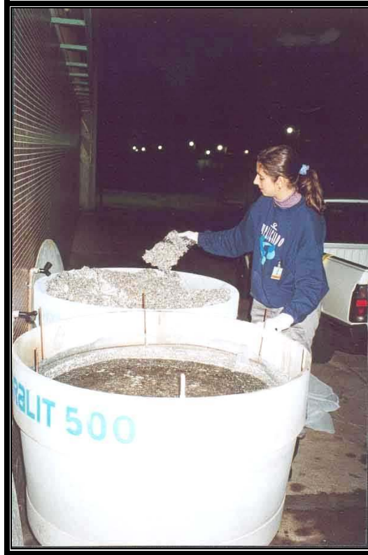
Figura 4.9: Lavagem do material moído
