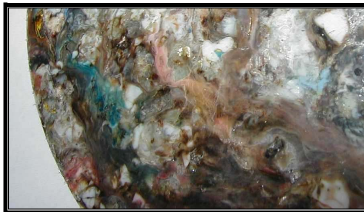
Figura 5.10: Placa de material lavado e decantado prensado na temperatura de 230°C.
