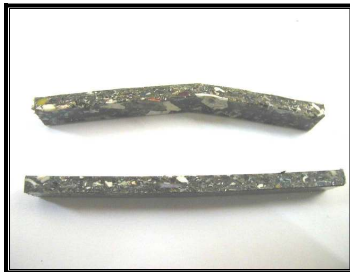
Figura 5.8: Laminação na placas de material limpo sobrenadante aglutinado
