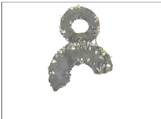
Figura 5.3: Partículas metálicas aderidas ao ímã
