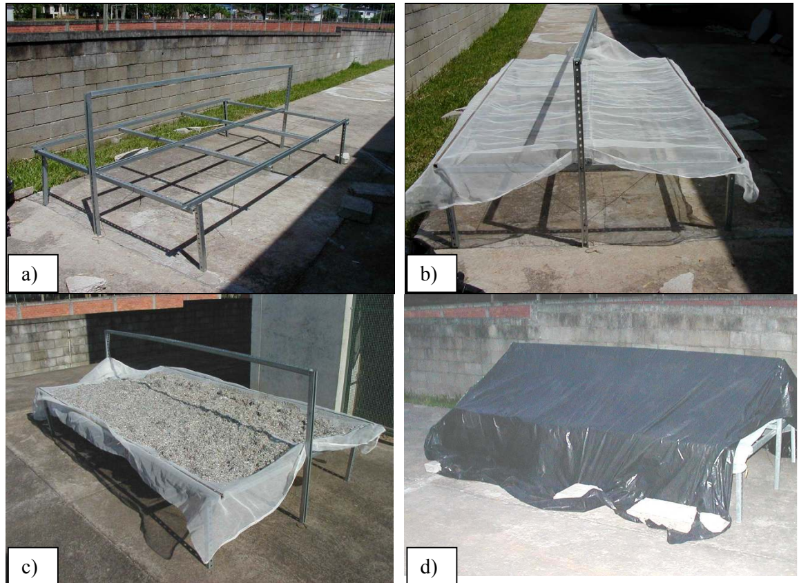
Figura 4.13: Secagem do material na estrutura de aço inoxidável.
