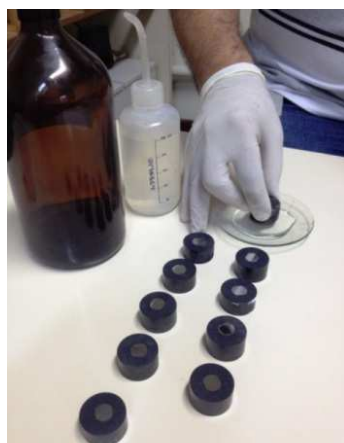
Figura 32 Ataque químico na superfície com solução de Nital 3%
