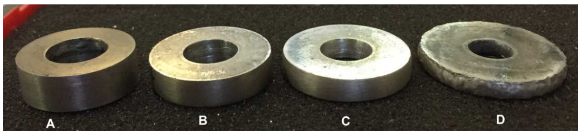
Figura 43 A) anel inicial, B) deformação relativa ( \epsilon ) de 20%, C) deformação relativa ( \epsilon ) de 40%, e D) deformação relativa ( \epsilon ) 60%.
