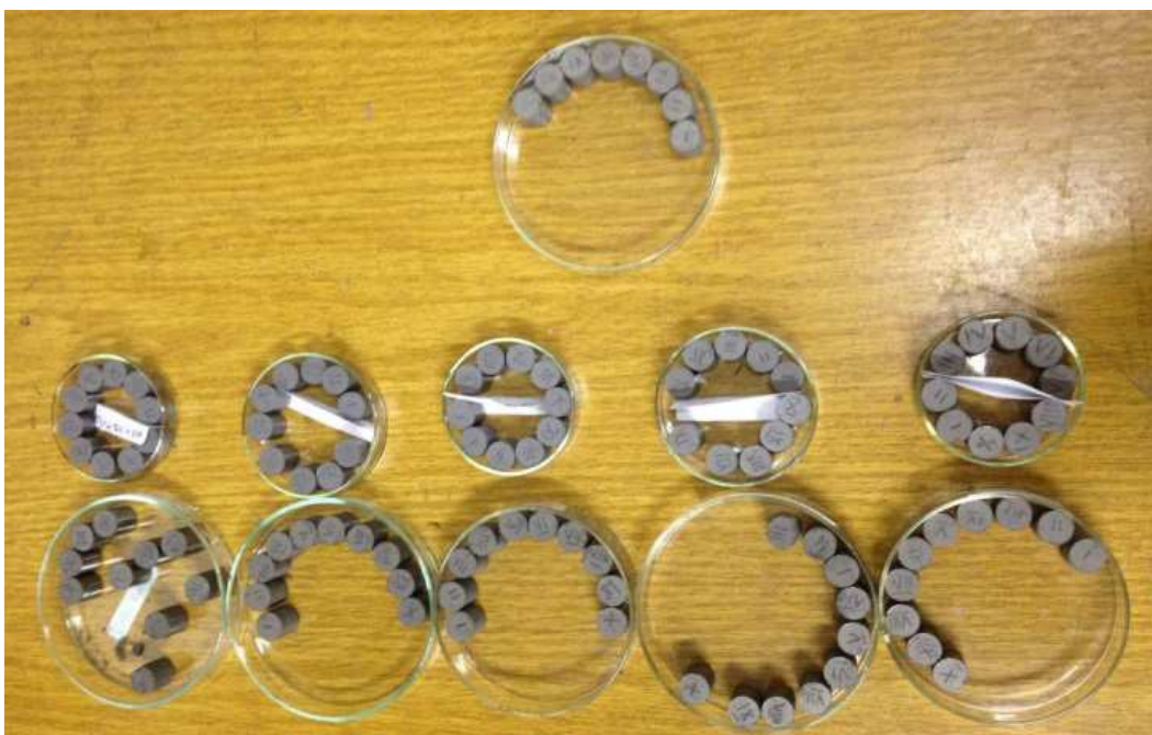
Figura 28 Vista superior das misturas compactadas no formato de cilindros para obtenção das densidades a verde.
