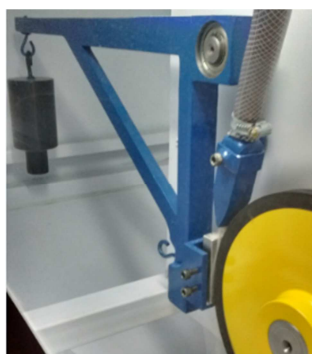
Figura 35 - Equipamento de ensaio abrasivo "areia seca / disco de borracha"
