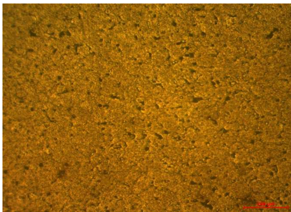
Figura 47 - Amostra H X (3% de MoS 2 a 1.000 N/mm 2 ) - Temperada e revenida – Ampliação de 100X
