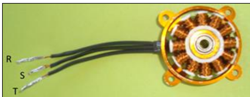
Figura 33 - Estator sinterizado em bloco único de Fe1%P do mini-motor instalado na carcaça.
