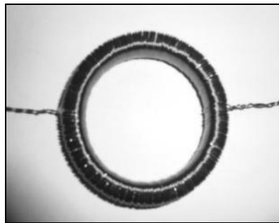
Figura 20 - Anel de Rowland (Toroidal) para ensaio das características magnéticas.
