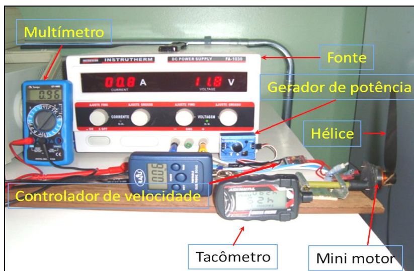
Figura 24 - Bancada de teste para ensaios do mini-motor.
