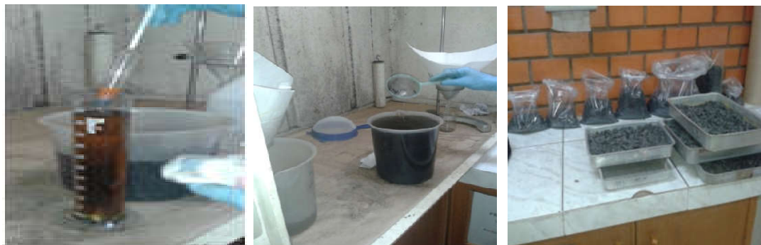
Figura 22 -Instrumentos e frações de carvão obtidas no ensaio afunda-flutua
