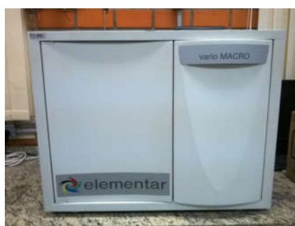
Figura 24- Equipamento de analisador elementar de marca Vario Macro
