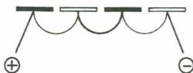
FIGURA 6.4. - Montagem característica do sistema Preto e Branco.
