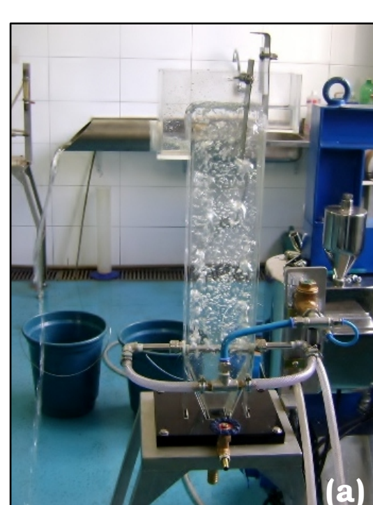
Figura 2. (a) Imagem do Hydrofloat operando com água e ar. (b) Ilustração do amostrador utilizado para as medidas de holdup .
