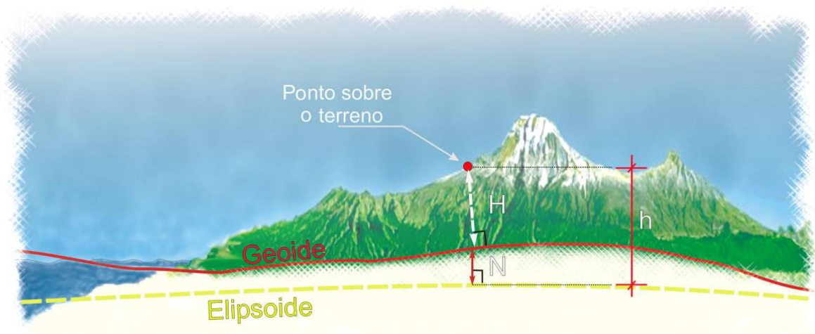
Figura 31 - Esquemática da relação entre o elipsóide e do geóide da Terra
