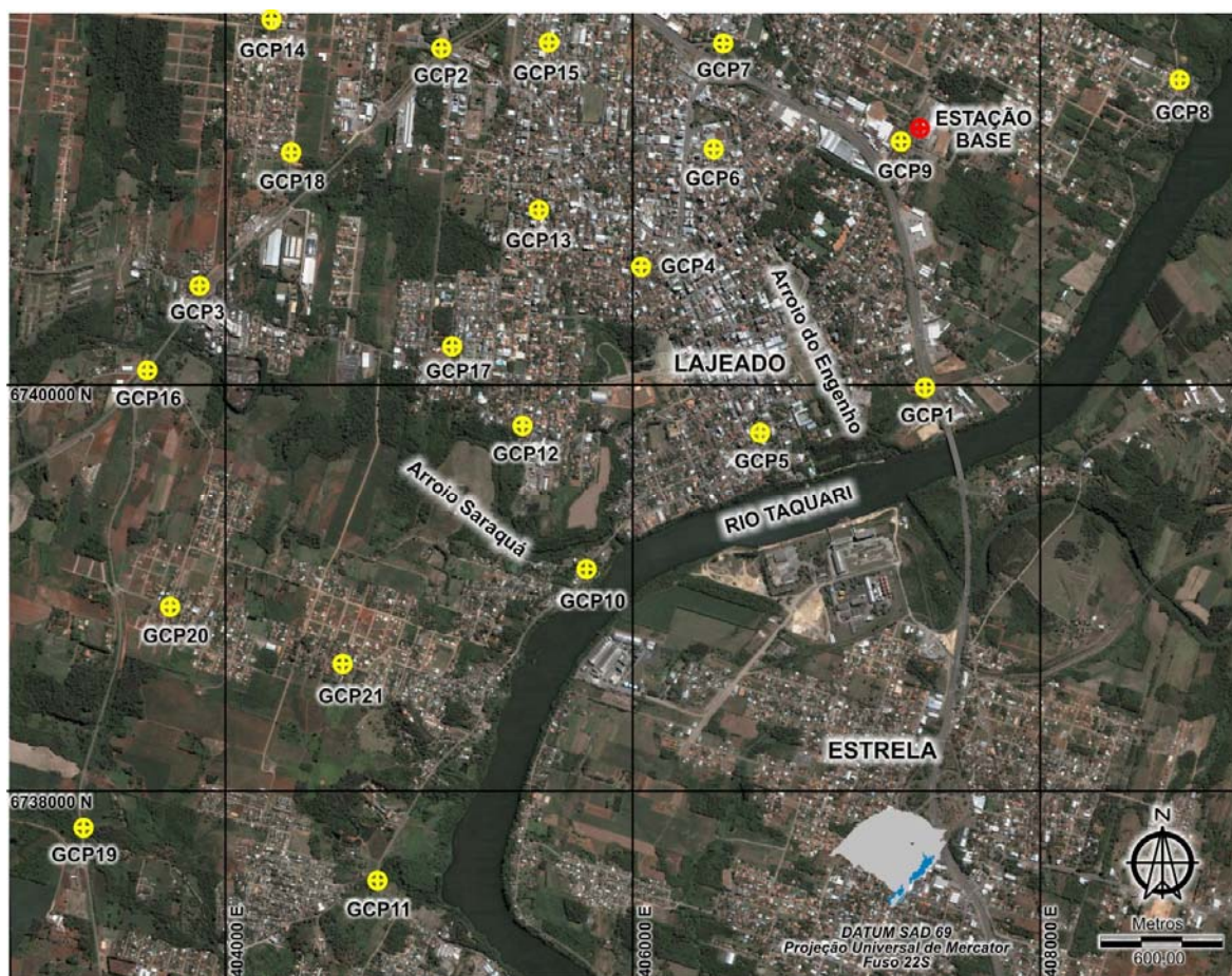
Figura 28 - Distribuição dos GCP e localização da estação-base
