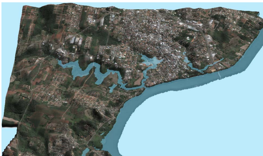
Figura 39 - c - Cota de inundação de 19 metros
