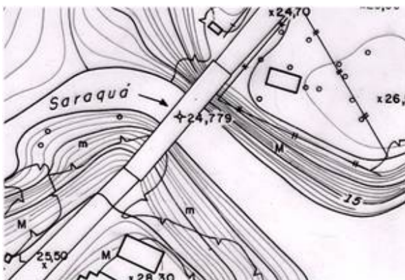
Figura 32 - Carta topográfica original georreferenciada 1:2.000 Figura 33 - Digitalização das curvas de nível georreferenciadas
