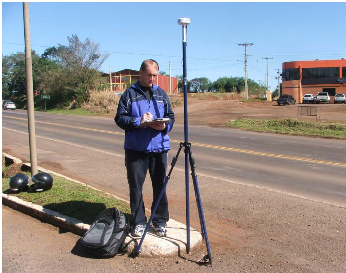
Figura 29 - Coleta do GCP16 com o DGPS GTR-A BT
