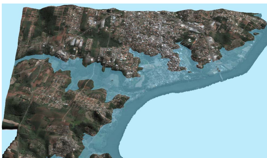
Figura 39 - f - Cota de inundação de 28 metros
