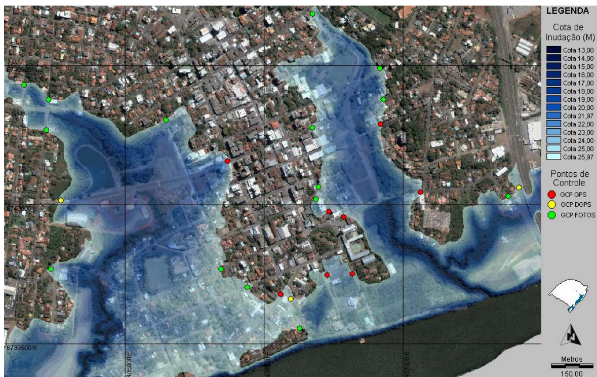
Figura 43 - Validação horizontal da cota de inundação simulada de 25,97 m
