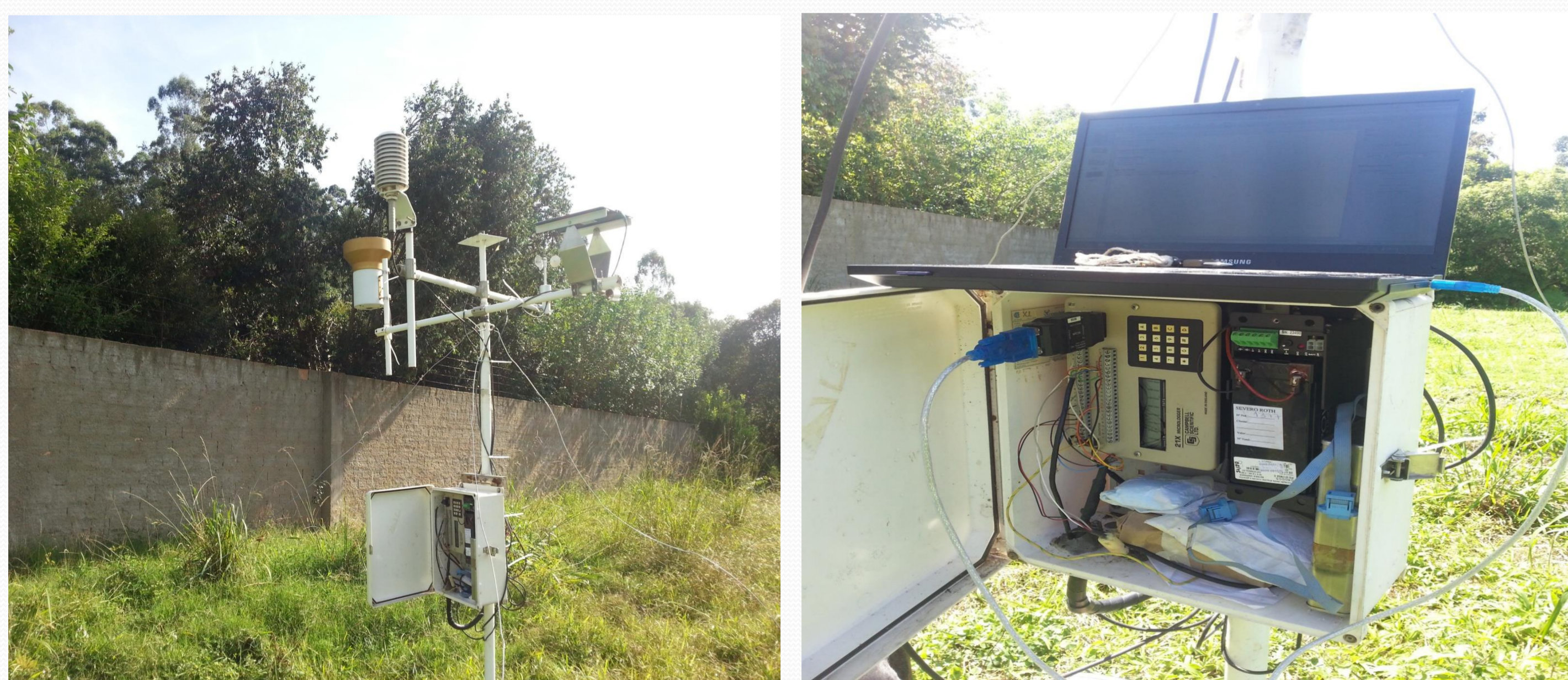
Figura 1. Estação meteorológica (esquerda) e seu sistema de aquisição de dados (direita) junto ao experimento. Lomba do Pinheiro, Porto Alegre, 2014/2015.
