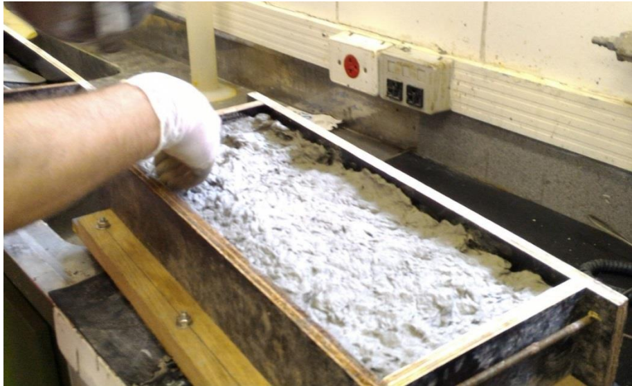
Figura 24 – Concretagem do ECC
