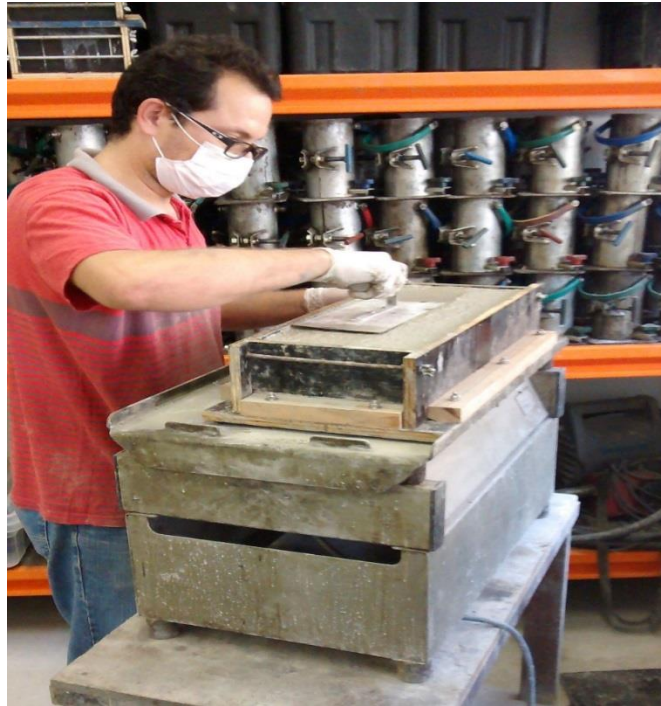
Figura 25 – Utilização da mesa vibratória
