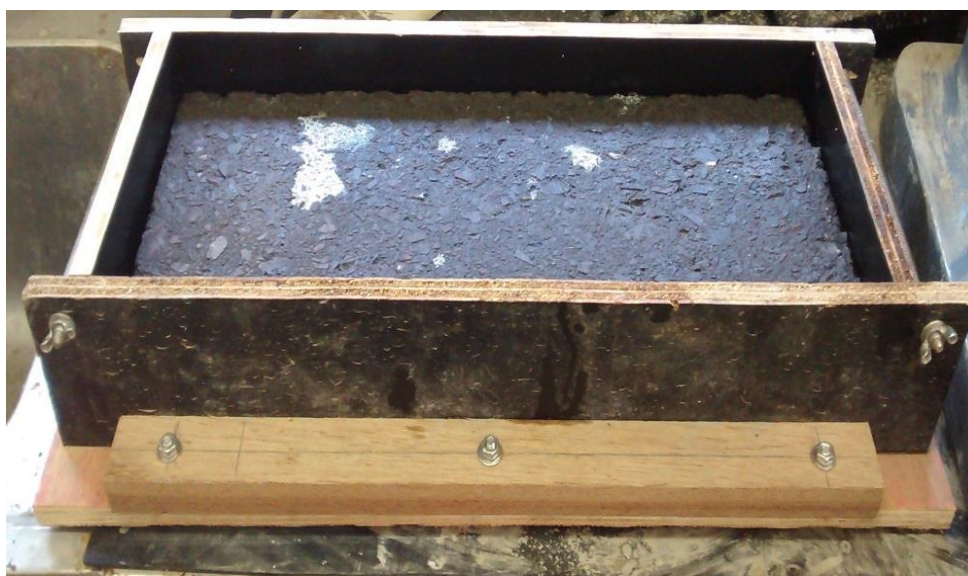
Figura 23 – Fôrma com a placa de concreto asfáltico
