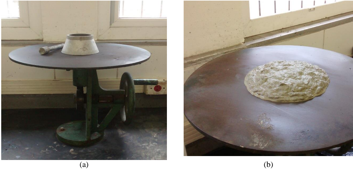
Figura 22 – (a) modelo da flow table utilizado no ensaio e (b) resultado de um ensaio de avaliação da trabalhabilidade do concreto
