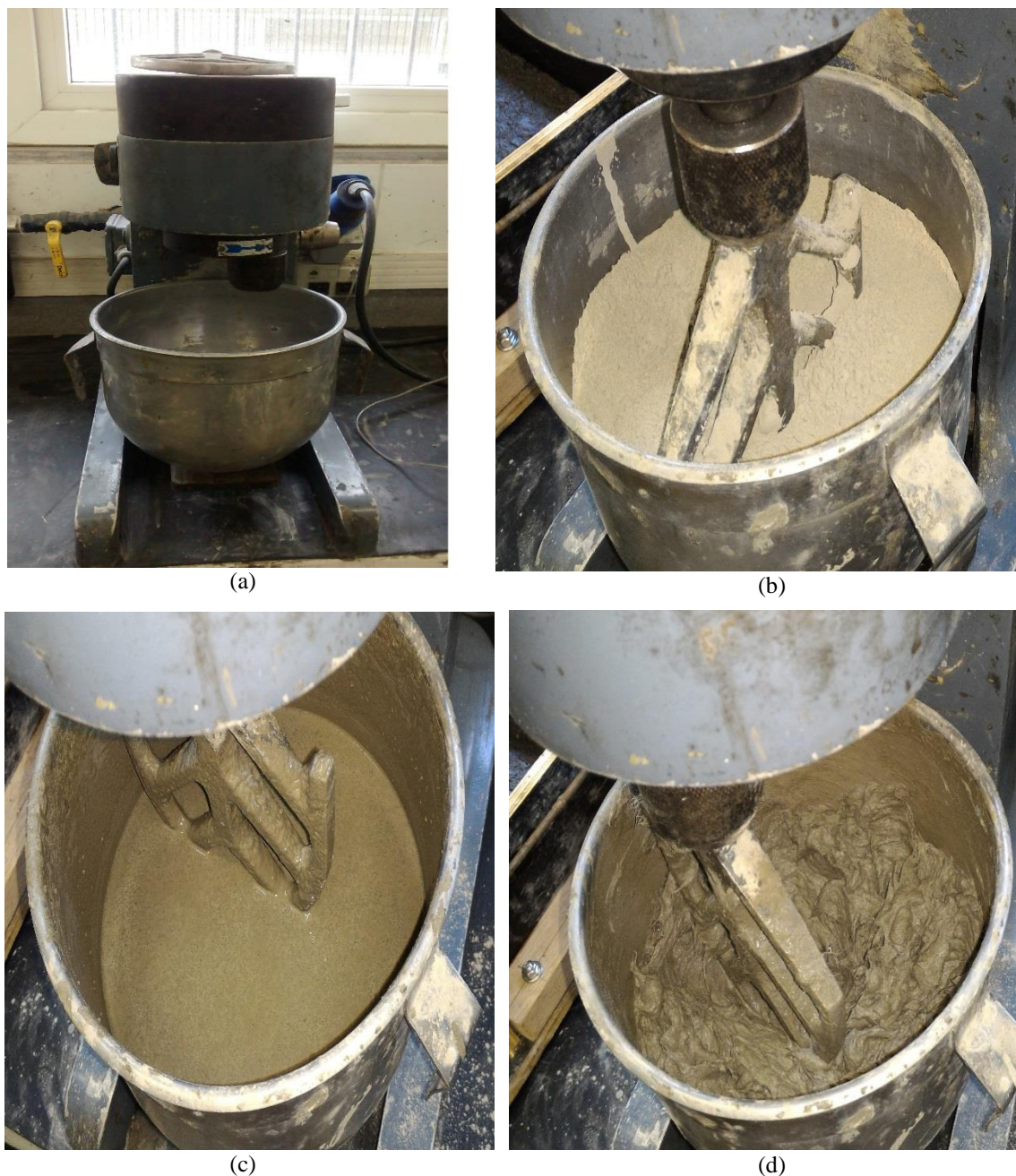
Figura 21 – Preparação do ECC (a) misturador usado no trabalho; (b) mistura dos materiais secos; (c) mistura após a adição de água e aditivo (d) mistura após a adição das fibras de polipropileno
