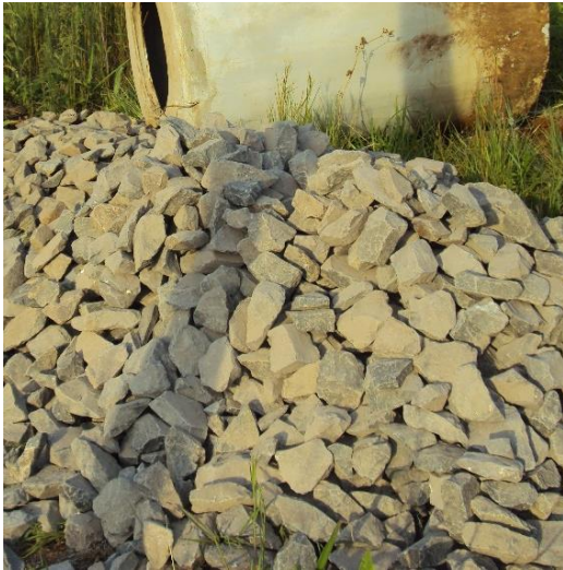
Figura 19 – Brita muito grande para preenchimento do leito do filtro
