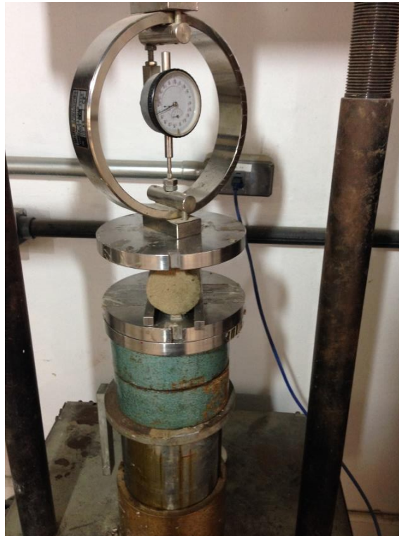
Figura 27 – Ensaio de resistência à compressão diametral em um corpo de prova da mistura de areia de Osório
