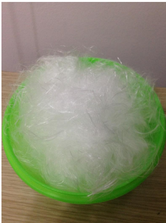
Figura 20 – Fibras de polipropileno de 24 mm de comprimento e 0,023 mm de diâmetro após serem desfiadas
