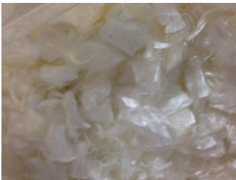
Figura 19 – Fibras de polipropileno de 24 mm de comprimento e 0,023 mm de diâmetro antes de serem desfiadas
