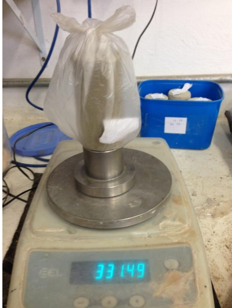
Figura 24 – Corpo de prova da mistura de areia de Osório sendo pesado e armazenado em saco plástico
