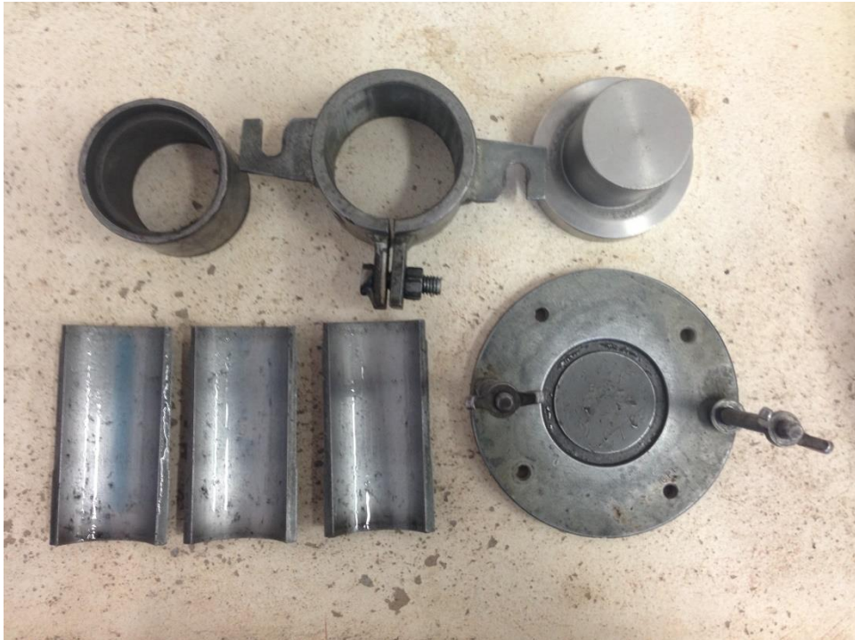
Figura 22 – Molde metálico tripartido desmontado
