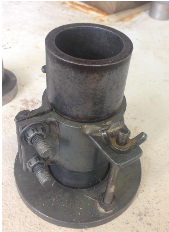
Figura 23 – Molde metálico tripartido montado
