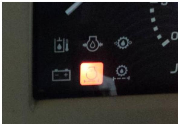
Figura 3.10 – Sinal luminoso do painel de instrumentos aceso, indicando que o limite de restrição indicado foi atingido.
