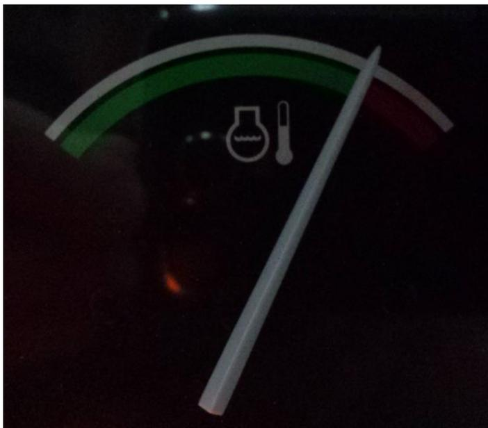
Figura 3.7 - Indicador analógico de temperatura demonstrando entrada em região crítica de temperatura.
