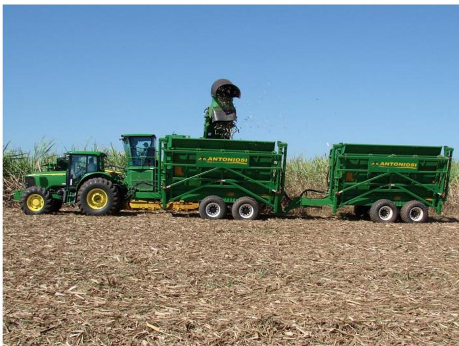
Figura 3.5 - Trator acoplado a duas carretas de transbordo marca Antoniosi, cada uma com capacidade de 10,5 toneladas de carga, trabalhando ao lado de uma colhedora de cana-de-açúcar (fonte: site da Antoniosi)
