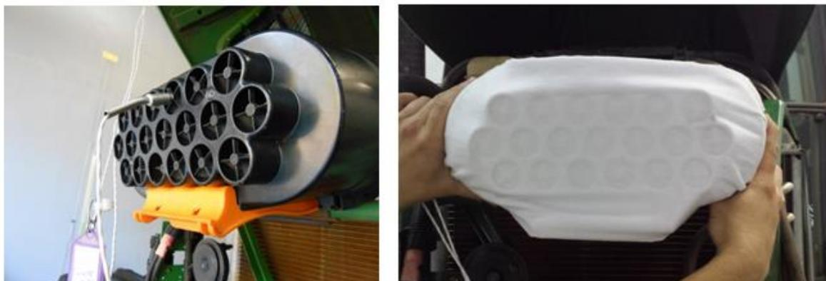
Figura 3.9 – Admissão de ar em condição ideal (livre de restrições e com filtros novos) a esquerda, e em condição extrema a direita.
