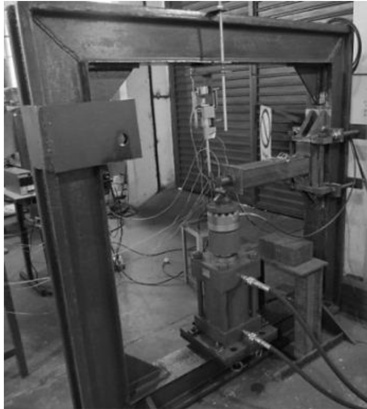
Figura 19 Vista geral do sistema montado para o ensaio de flexão simples.
