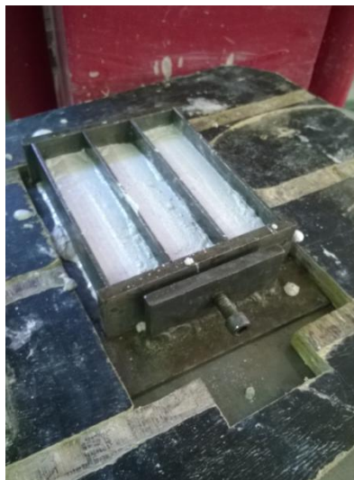
Figura 29 – Moldagem dos corpos de prova prismáticos
