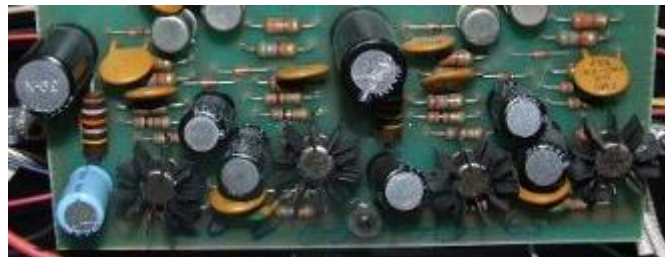
Figura 1: Placa contendo diversos capacitores cerâmicos (do tipo "moeda") e eletrolíticos (cilíndricos).
