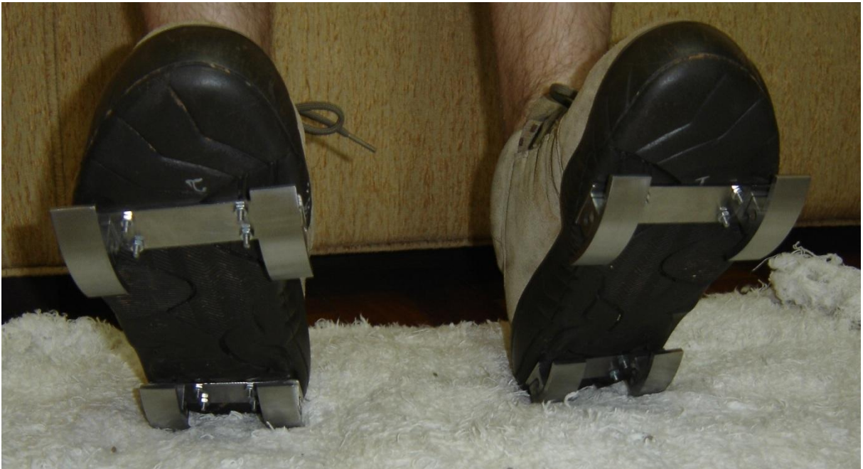
Figura 3.18: As duas plataformas de força móvel engastadas ao solado do calçado.
