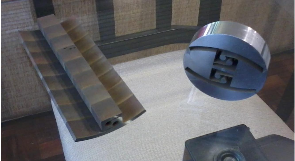
Figura 3.15: As oito células de carga usinadas em aço AISI 420C e um dos discos no qual foi recortado duas células de carga em máquina de eletroerosão a fio.
