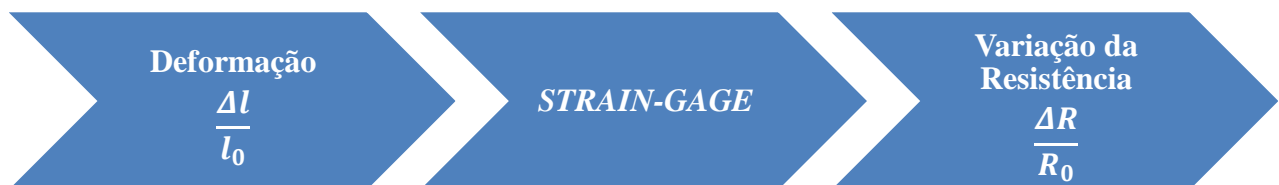
Figura 2.5: Diagrama causa/efeito do princípio de funcionamento do strain-gage .
