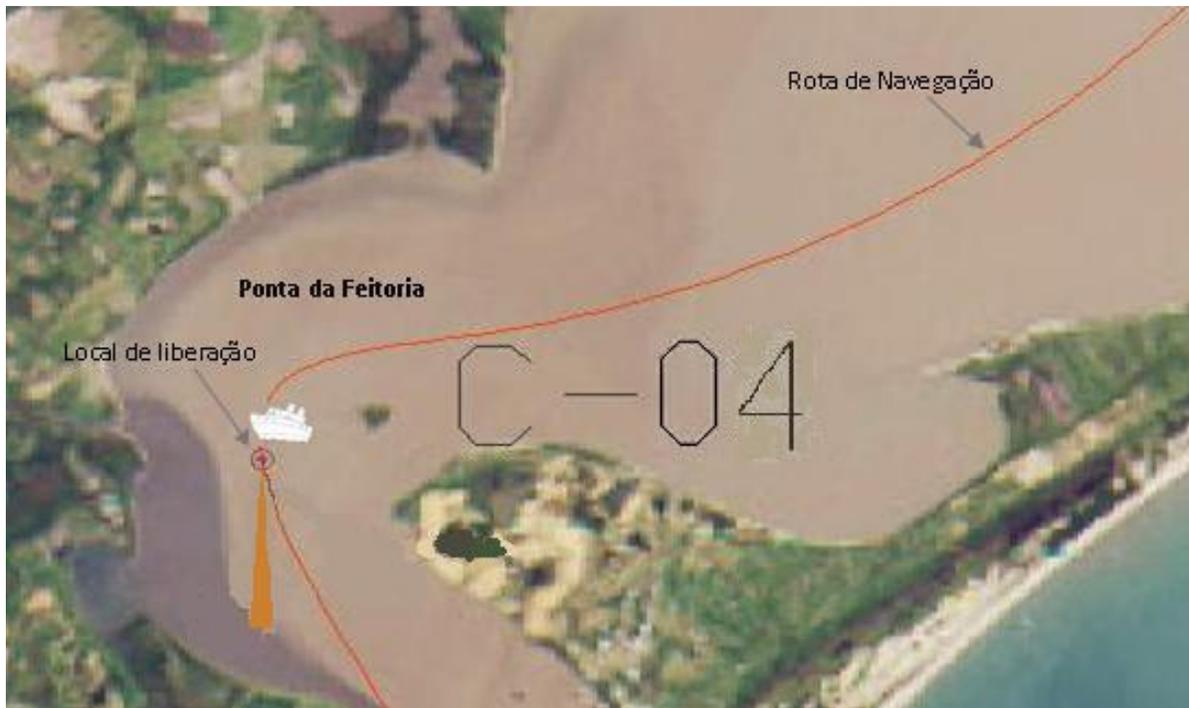
Figura 9.2.2.3: Posição da poça 3 h após a liberação.
