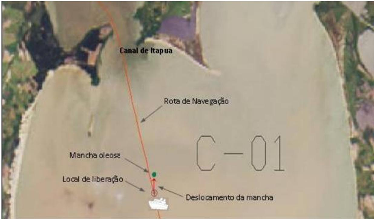
Figura 9.1.1.2: Posição da poça 1h após a liberação.
