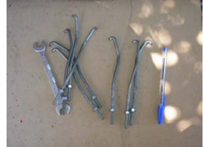
Figura 14 – Detalhe dos parafusos de tensão. Foto Mario Maia, 2006.
