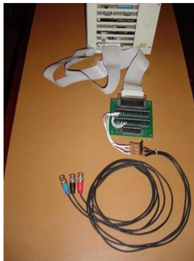
Figura 3.7 – Placa de Interface acoplada a placa de aquisição de dados no PC.
