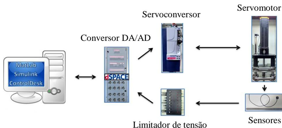
**Figura 87 - Esquemático da interação entre os principais elementos constituintes da bancada de testes.**
