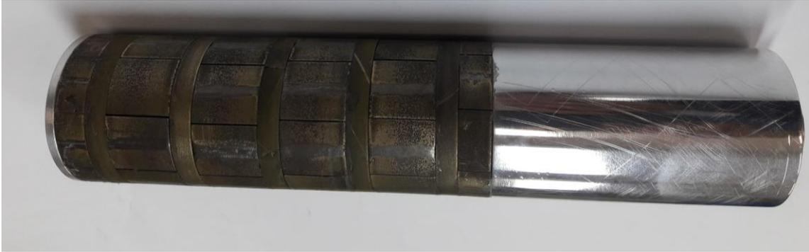
**Figura 80 - Fotografia do arranjo interno de quase-Halbach montado.**
