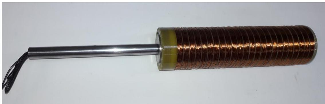
**Figura 83 - Fotografia da estrutura móvel do atuador, ou seja, bobina, carretel e eixo.**
