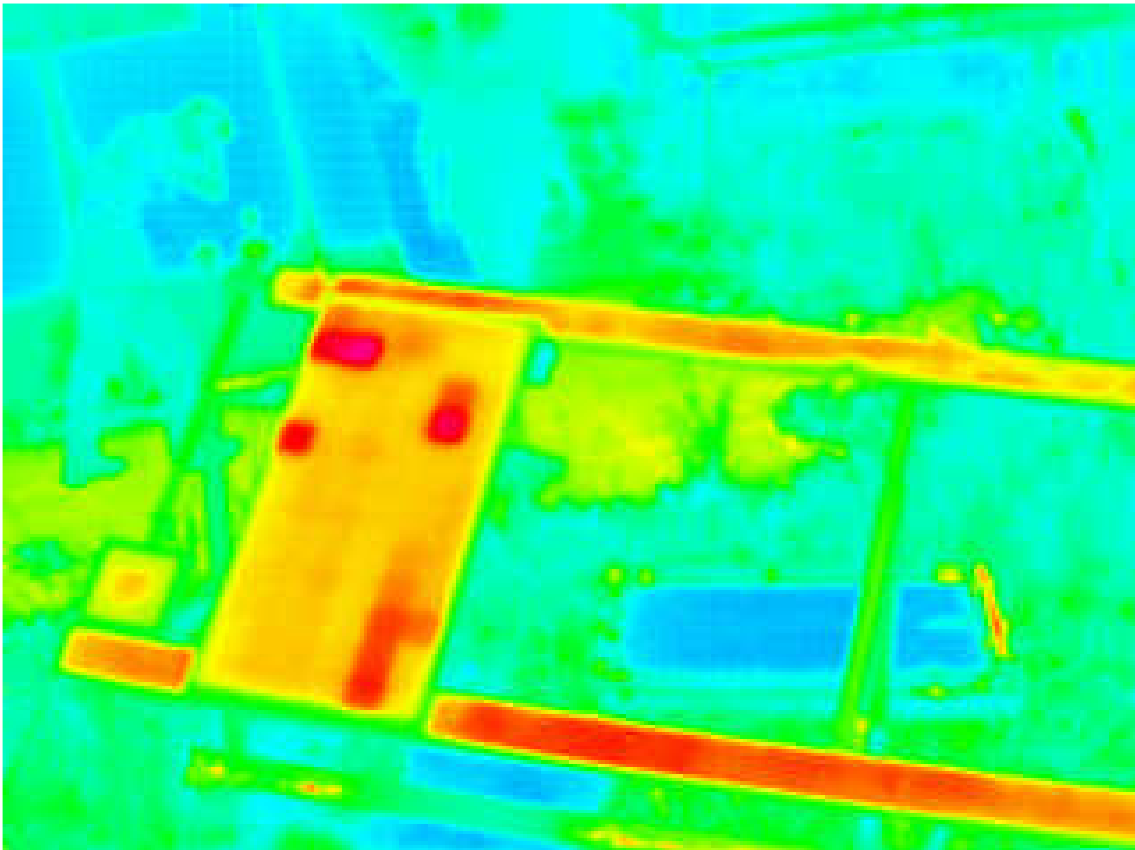
Figura 6.28-Imagem 4 da seqüência de termografias do módulo em curto-circuito (32 s).
