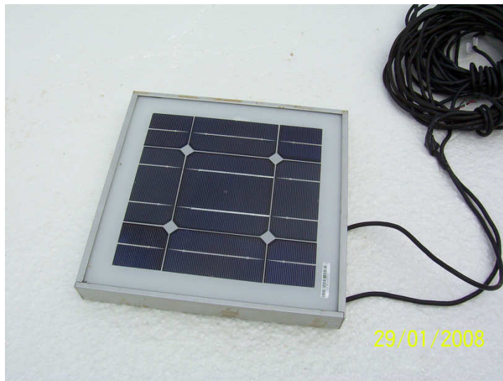
Figura 5.28-Célula fotovoltaica utilizada para medir a irradiância.
