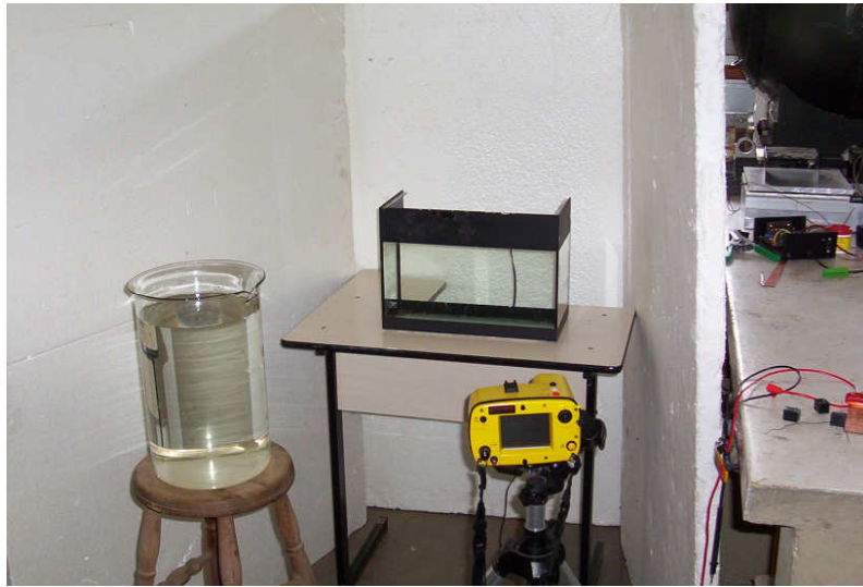
Figura 5.9-Montagem experimental de um copo de Becker refletindo sobre um aquário.
