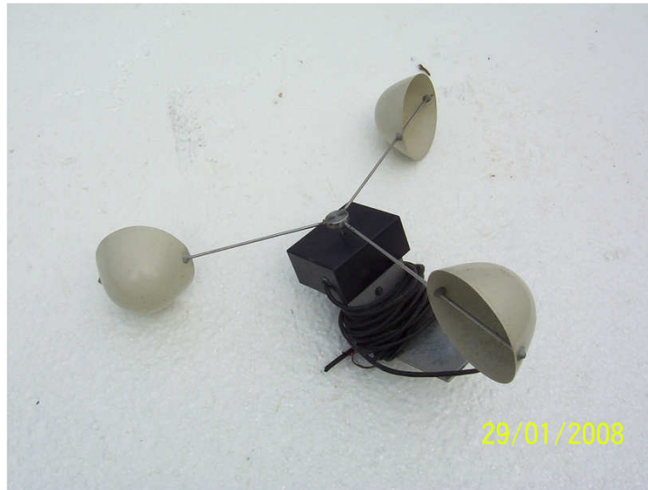
Figura 5.27-Anemômetro utilizado para medida da velocidade do ar.
