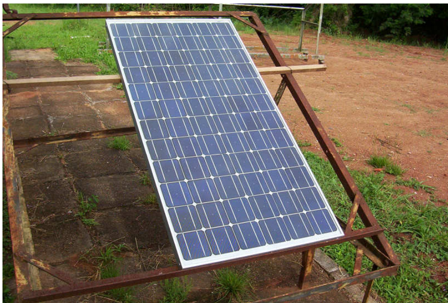
Figura 4.4-Módulo fotovoltaico do modelo ISOFOTON–I–100.
