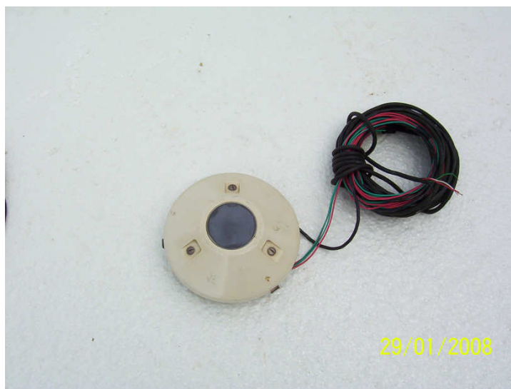
Figura 5.29-Pirgeômetro utilizado para medir a temperatura efetiva do céu.
