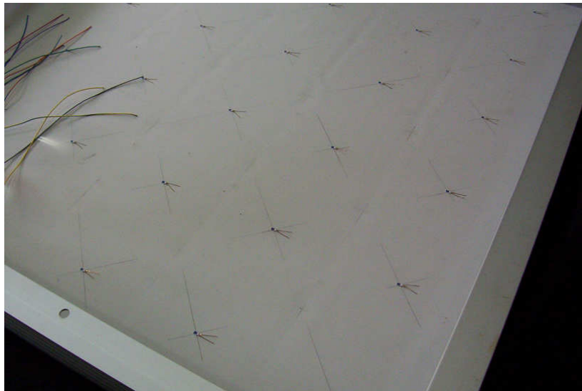
Figura 5.22-posição da colagem dos PT100 na parte posterior do módulo.
