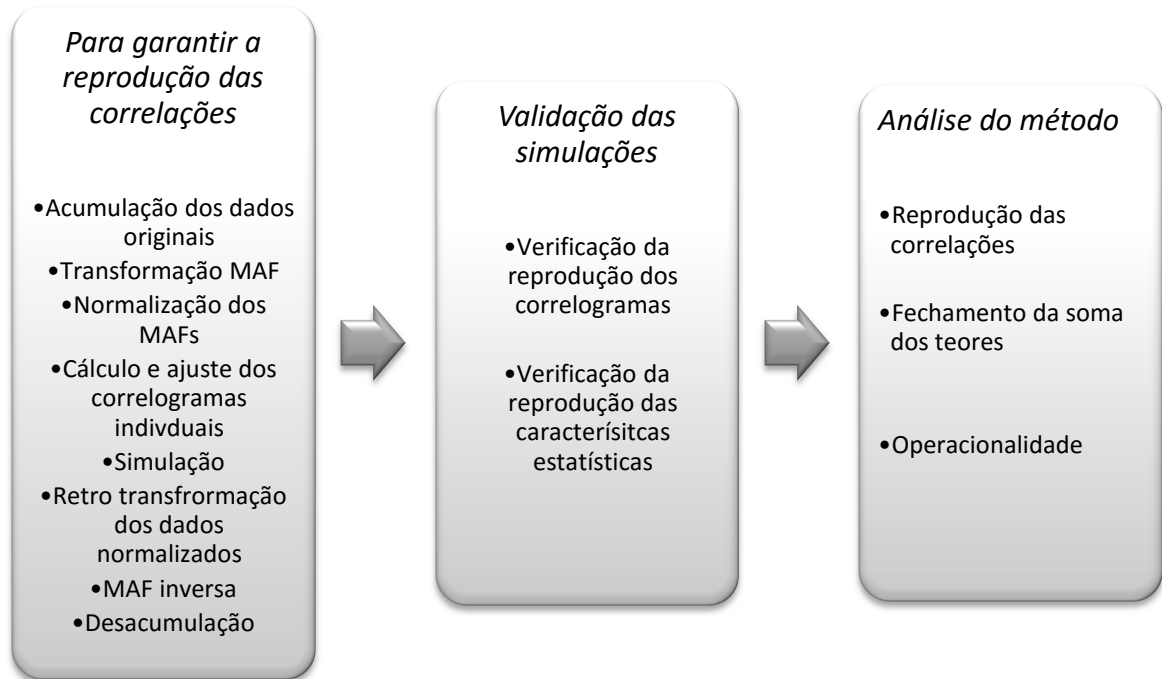
FIGURA 1.4:fluxograma da metodologia para a combinação III.
