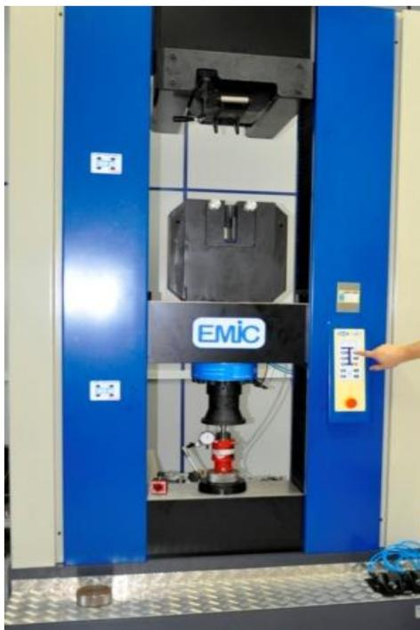
Figura 2.24: Máquina de ensaios EMIC com capacidade de 600kN
