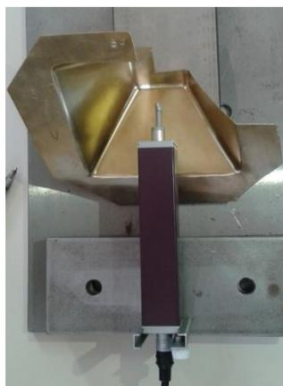
*Figura 4.16: Medição da rugosidade da amostra.*
