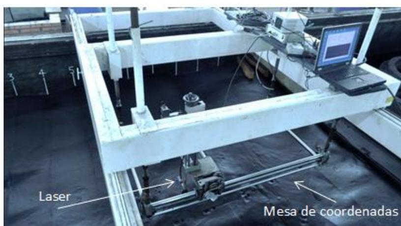
**Figura 18:** Laser MD250ADV acoplado à mesa de coordenadas, realizando leitura topográfica do depósito do modelo.
