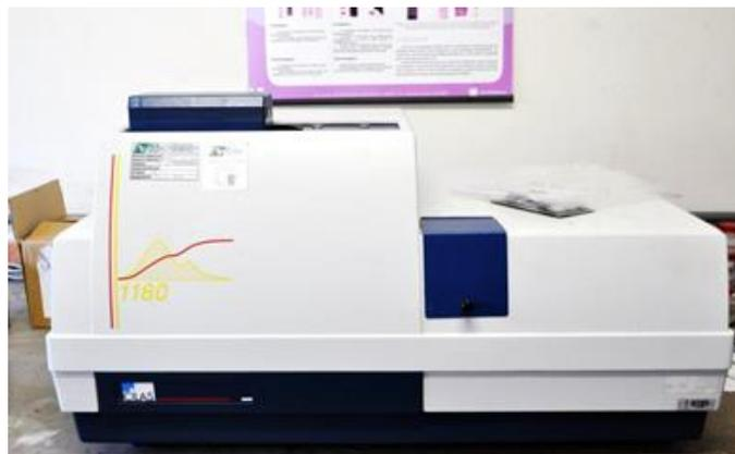
**Figura 17:** Analisador de partículas a laser modelo Cilas 1180.
