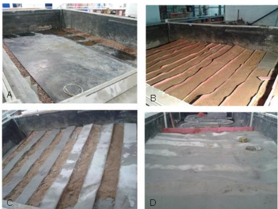
**Figura 13:** Etapas da construção do modelo. A-chapa metálica (base da topografia), B-lançamento dos perfis e preenchimento com areia, C- modelagem do relevo com argamassa, D-modelo finalizado.
