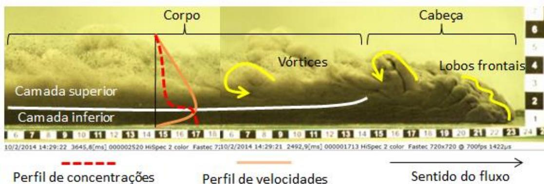
**Figura 3** Corrente de densidade simulada em canal bidimensional. Fonte: Imagens captadas por uma câmera de alta velocidade no NECOD (2014) durante experimentos do projeto “Processos I”.
