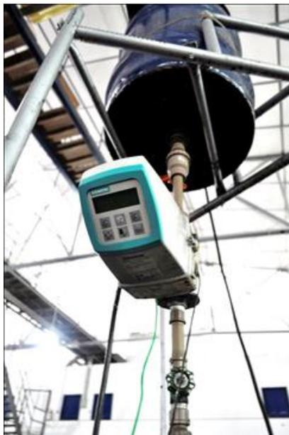
**Figura 16:** Medidor de vazão eletromagnético Siemens MAG500 acoplado ao sistema de alimentação do modelo.
