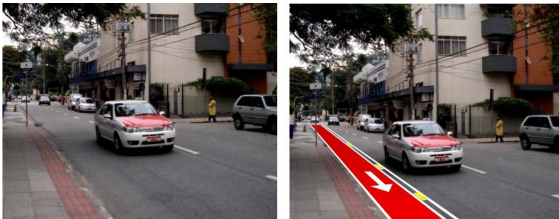
Figura 2: Exemplo de aproveitamento do espaço viário para implantação de ciclofaixa Fonte: Miranda (2009)
