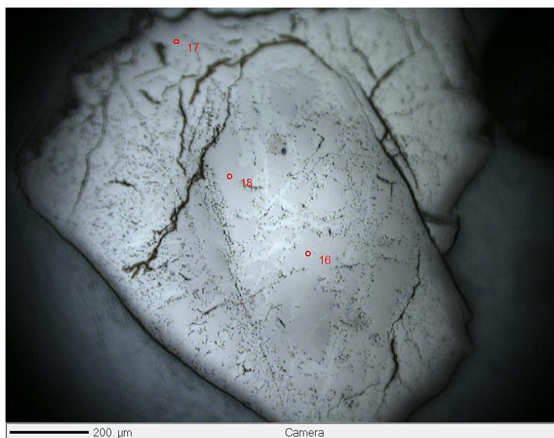
Figura 6.38 - - Imagem do microscópio óptico de luz refletida de grão de Mn-ilmenita que possui o ponto 17 ou análise 17 com Mn enriquecido. Ver Tabela 6.9.
