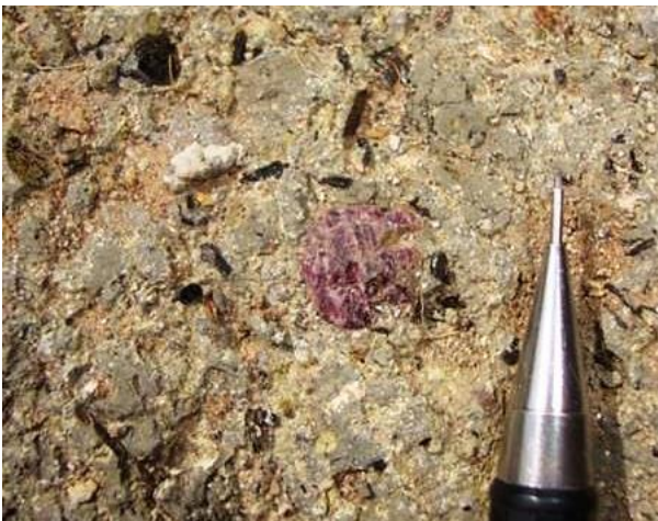
Foto 4.4 - Macrocrystal de granada com até \approx 1,0 cm, cor violeta, subédrico, com vértices arredondados e fraturas pervasivas.
