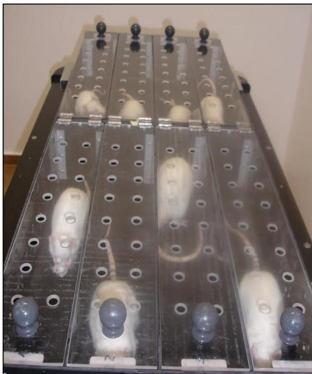
**Figura 8.** Esteira ergométrica adaptada para ratos
