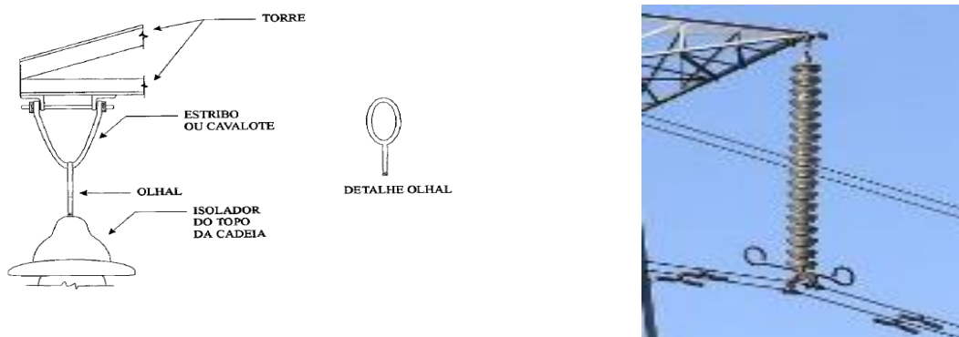
Figura 3.2 – Conexão entre isoladores e torre.
