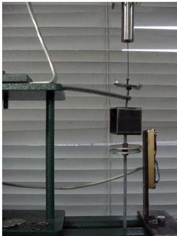
Figura AV. 2: Viga deformada
