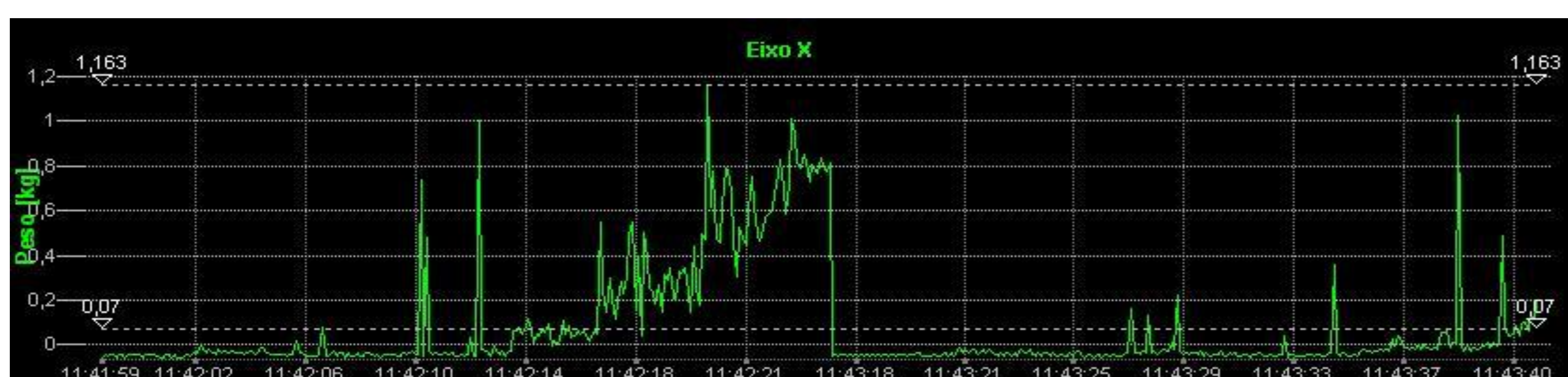
Fig 3: Compressões determinadas pela EI na descarga de laranjas em packinghouse.
