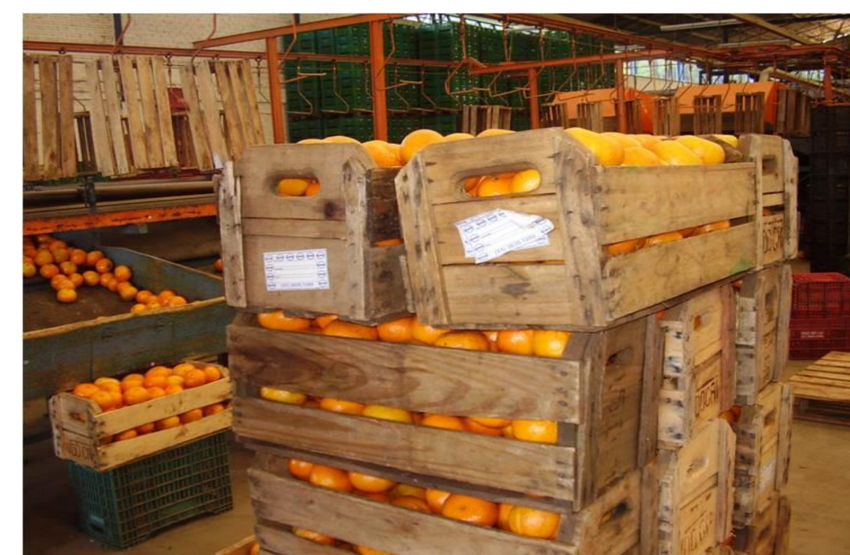
Fig 4: Problemas de não coincidência de bordas de caixas na palatização.
