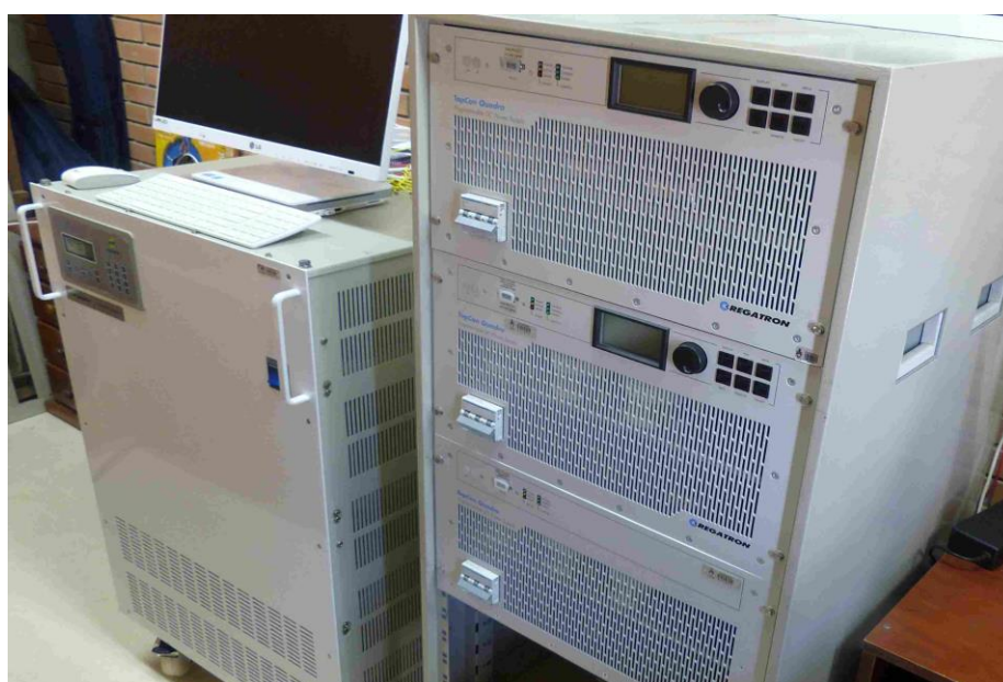
Figura 8.4 - Simulador de rede CA (à esquerda) e fonte simuladora de arranjos fotovoltaicos (à direita).
