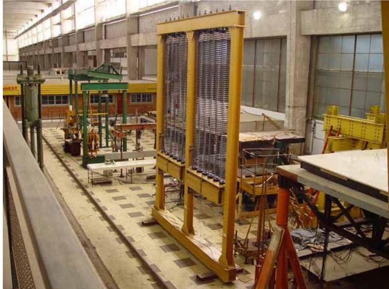
Figura 2.63 – Pórtico com 2 MADS preparado para ensaios no LABEST-COPPE/UFRJ (Battista e Pfeil, 2005).
