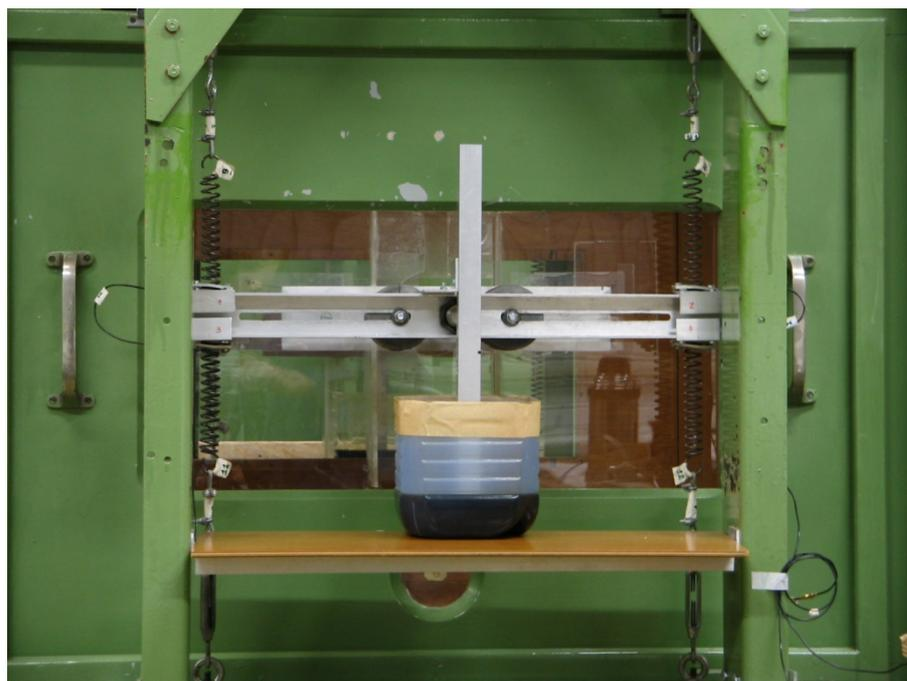
Figura 5.63 – Sistema de apoio elástico do modelo dinâmico com o dispositivo para incremento do amortecimento do sistema.
