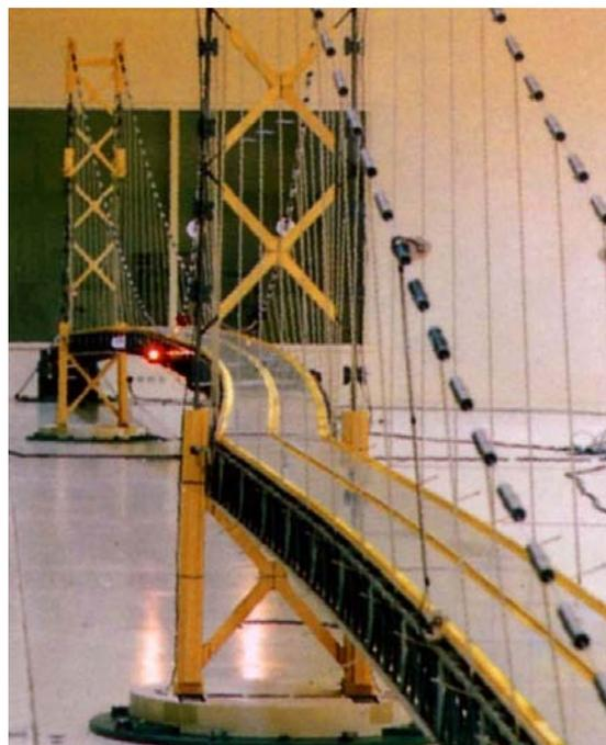
Figura 3.7 - Modelo da ponte *Akashi Kaikyo* deformado pelo vento (Miyata, 2003).
