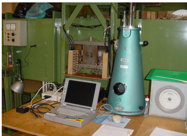
Figura 5.4 – Aparato experimental utilizado nos ensaios estáticos para medidas de pressões em modelos seccionais.
