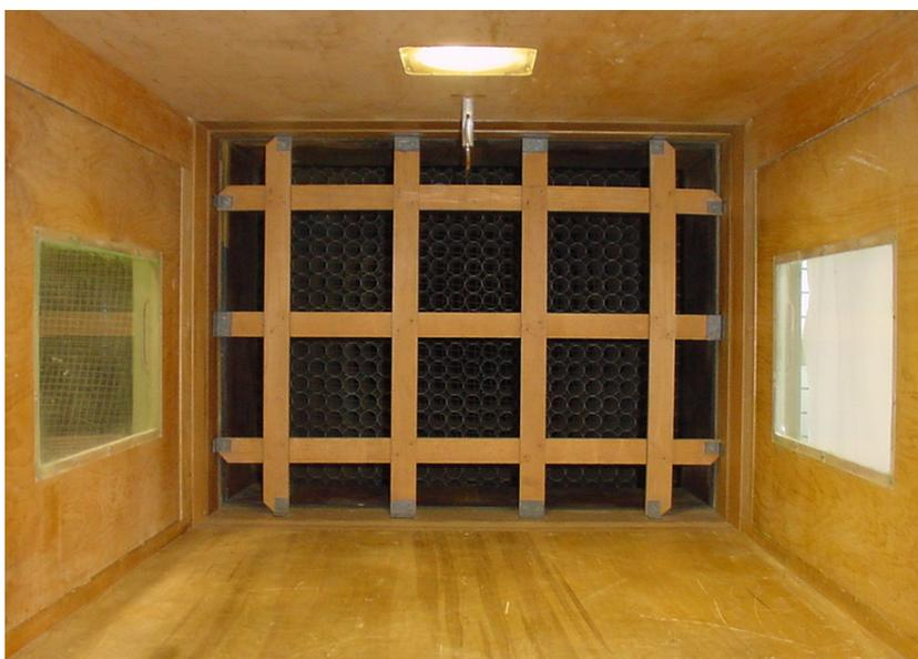
Figura 4.7 – Dispositivo gerador de turbulência – Grelha – G1.
