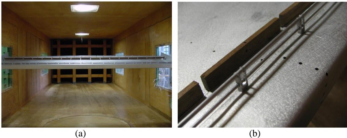
Figura 5.2 – (a) Modelo seccional para medida de pressões nos tabuleiros no interior do túnel de vento e (b) detalhe da instrumentação com tomadas de pressão.
