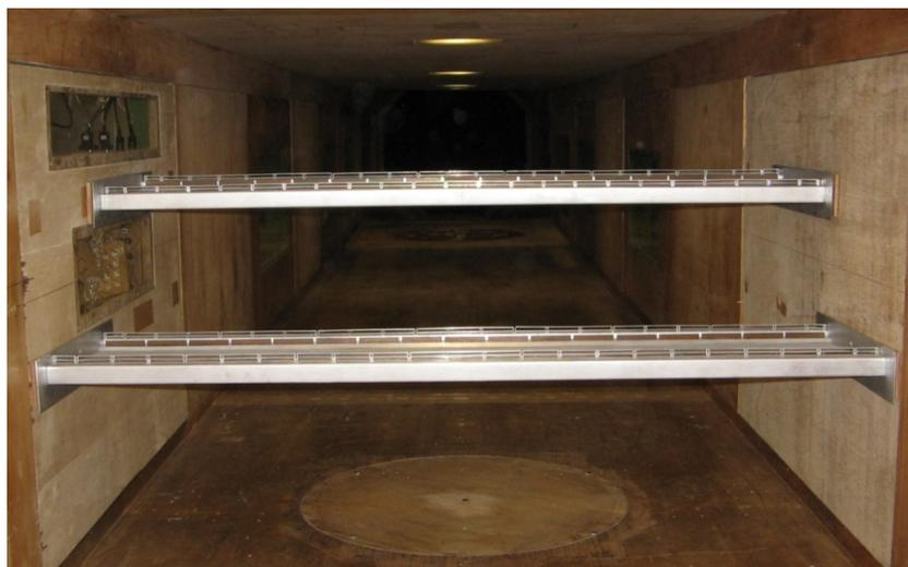
Figura 5.12 – Posicionamento relativo entre os modelos mudo e instrumentado com tomadas de pressão no interior do túnel de vento – diferentes cotas verticais.
