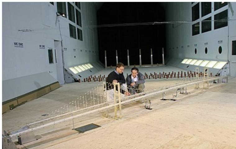
Figura 2.75 – Modelo aeroelástico completo das pontes paralelas de *Tacoma* – EUA no interior do túnel de vento.
