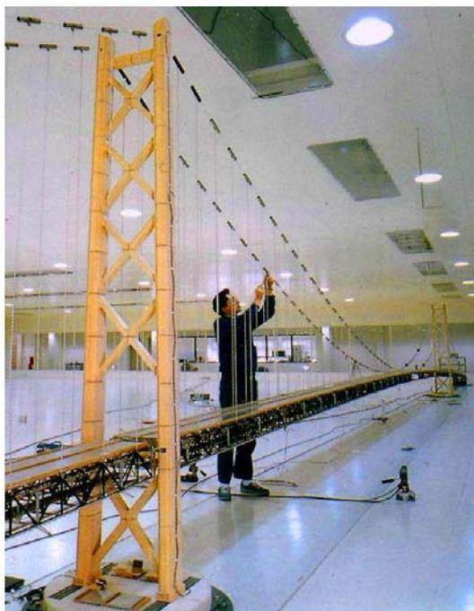
Figura 3.6 - Modelo da ponte *Akashi Kaikyo* no interior do túnel de vento (Simiu e Scanlan, 1996).
