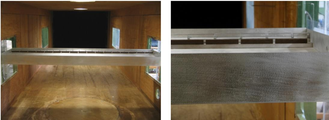
Figura 5.68 – Modelo com placas planas nos bordos do tabuleiro.
