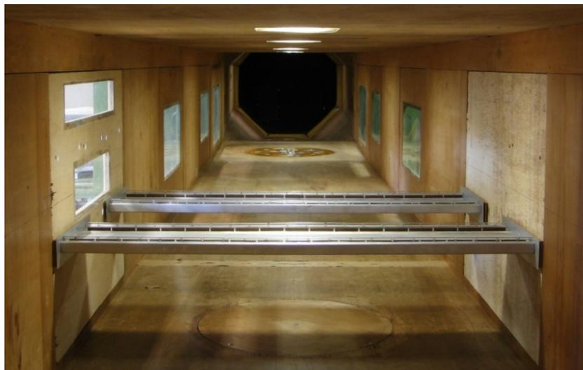
Figura 5.15 – Posicionamento relativo entre os modelos mudo e instrumentado com tomadas de pressão no interior do túnel de vento – mesma cota vertical.
