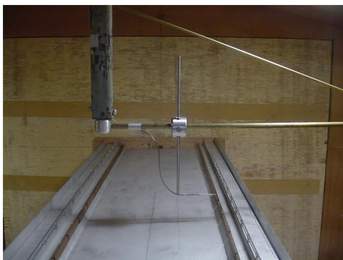
Figura 5.38 – Modelo e posicionamento do sensor de fio quente no interior do túnel de vento.
