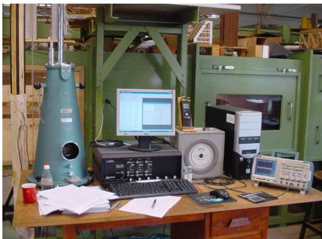
Figura 5.40 – Aparato experimental utilizado nos ensaios com anemometria a fio quente.
