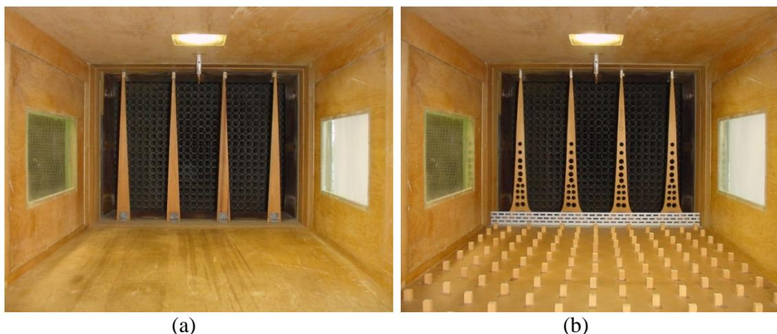
Figura 4.4 – Dispositivos de geração das diferentes camadas limites do túnel de vento *Prof. Joaquim Blessmann*. (a)  $p = 0,11$ ; (b)  $p = 0,23$ .
