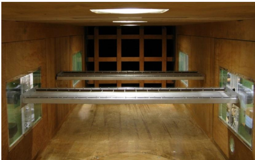
Figura 5.71 – Posicionamento relativo ( $2,0B$ ) entre os modelos dinâmico e mudo no interior do túnel de vento – mesma cota vertical.
