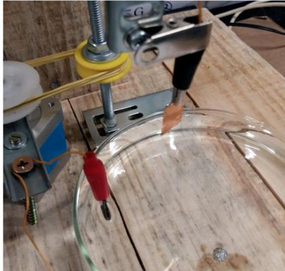
**Figura 17 - Amostra posicionada na presilha de cor preta suspensa sobre a solução com eletrodo vítreo imerso e preso pela presilha vermelha.**
