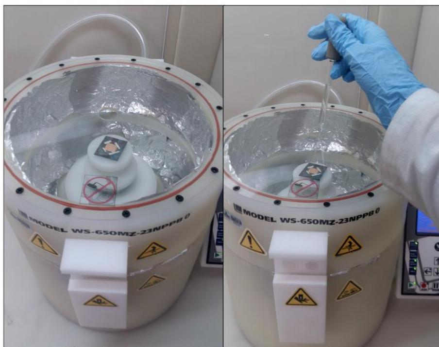
**Figura 16 - Amostra de Cobre/Grafeno no equipamento de *spin-coating*. Algumas gotas de solução são depositadas sobre a amostra por um orifício no vidro superior imediatamente antes da rotação começar.**
