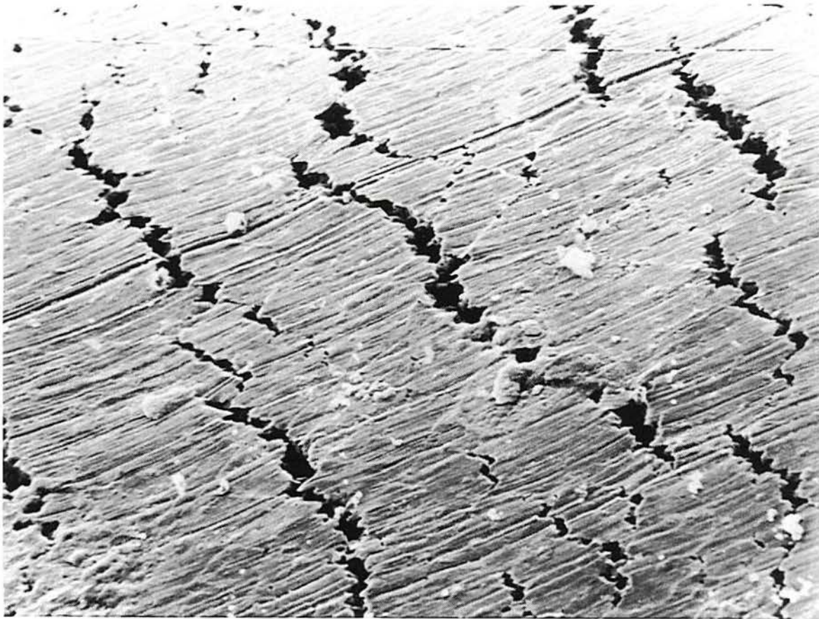
Figura 42– Fissuras encontradas em arames esferoidizados no potencial de -0.01 \text{ V}_{\text{enh}} na solução de \text{Ca(OH)}_2 + 0.05 \text{ M} de \text{NaCl} . Aumento: 320x
