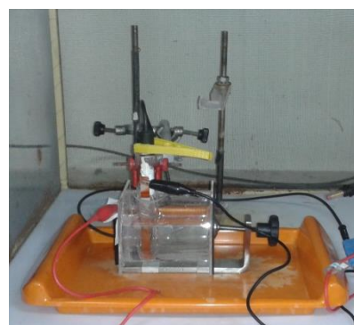
Figura 14: Potenciostato utilizado no ensaio de polarização. Fonte: Acervo próprio.
