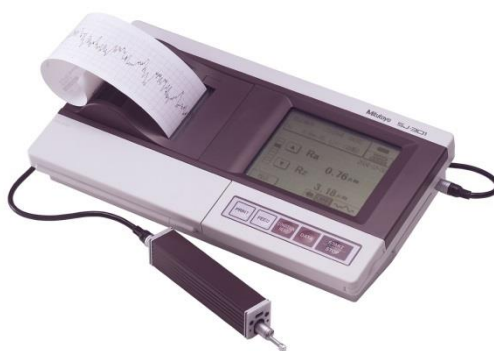
Figura 11: Rugosímetro digital utilizado nas medidas de rugosidade. [37]
