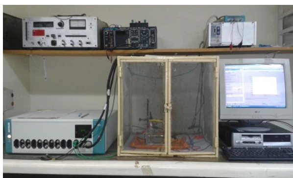
Figura 14: Potenciostato utilizado no ensaio de polarização. Fonte: Acervo próprio.
