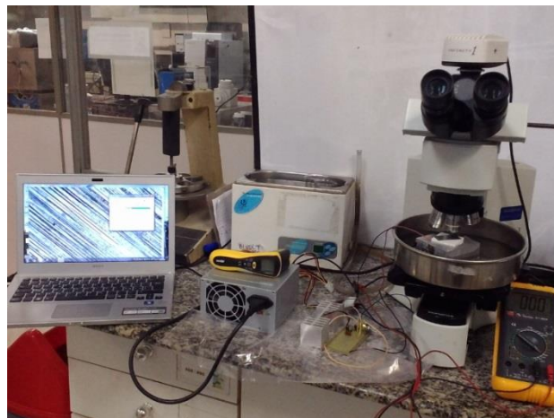
Figura 15: Sistema montado para a análise de congelamento durante a condensação de água das amostras expostas a baixas temperaturas. Fonte: Acervo próprio.
