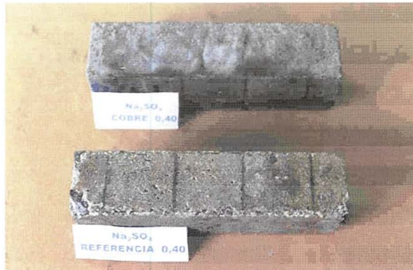
Figura 52 Aspecto de corpos-de-prova após 450 dias de imersão em solução de sulfato de sódio
