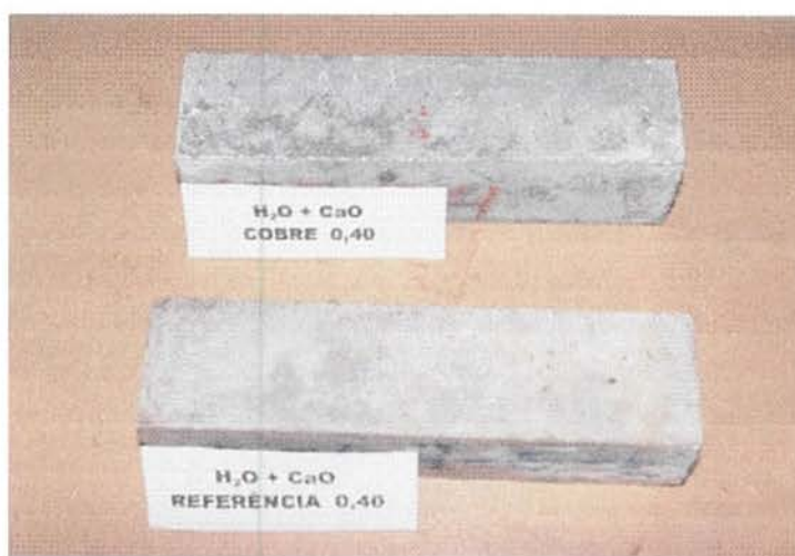
Figura 51 Aspecto de corpos-de-prova após 450 dias de imersão em água saturada com cal
