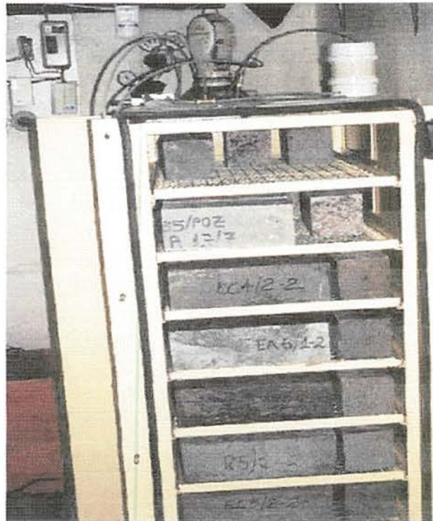
Figura 48 Aspecto da câmara de carbonatação com os corpos-de-prova
