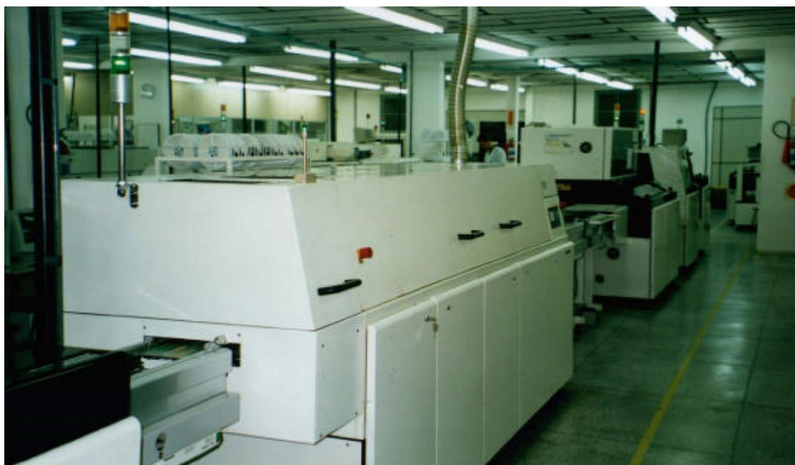
FIGURA 17: Máquina nova da linha de produção (SMT)
