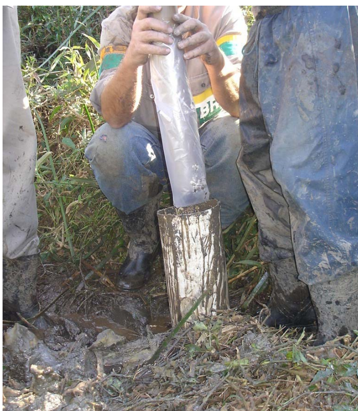
Figura 16. Cano de PVC revestido com saco plástico, para diminuir o contato da água com o equipamento
