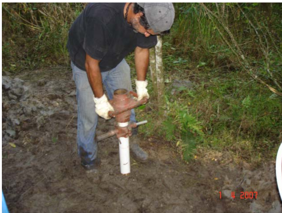
Figura 12. Perfuração com PVC cravado por percussão para amostragem de solo.
