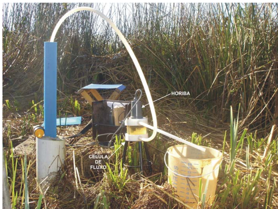
Figura 10. Célula de fluxo utilizada para medição dos parâmetros físico-químicos da água subterrânea durante a amostragem.
