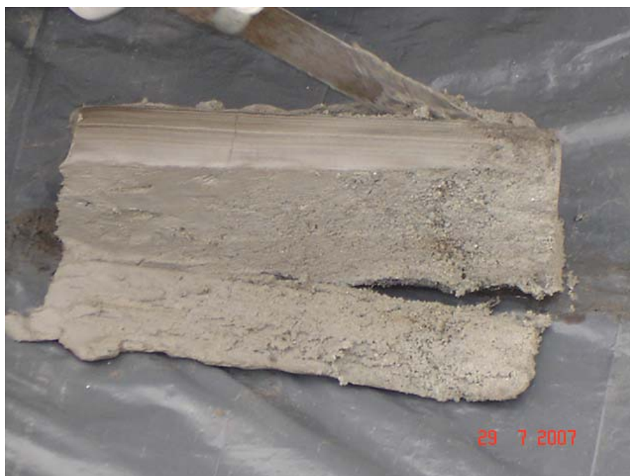
Figura 13. Limpeza do testemunho pela remoção das partes externas.
