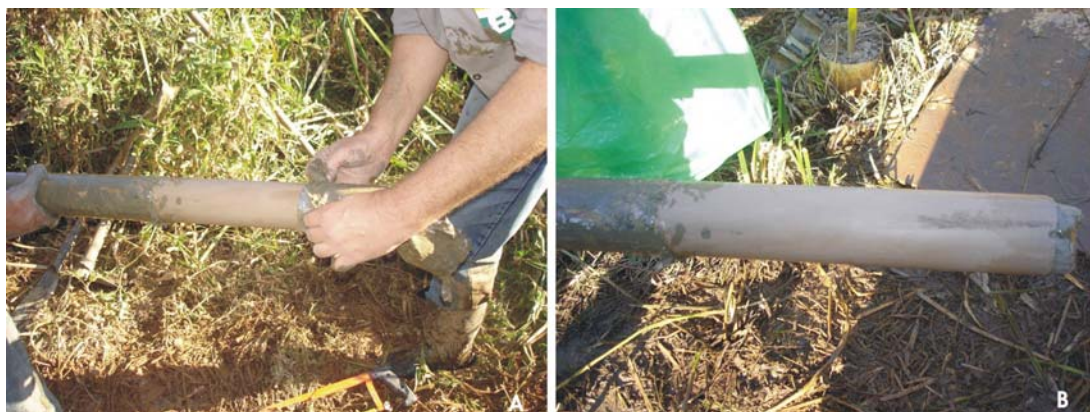
Figura 17. (A) saco plástico sendo retirado, (B) cano limpo após ser retirado o saco plástico
