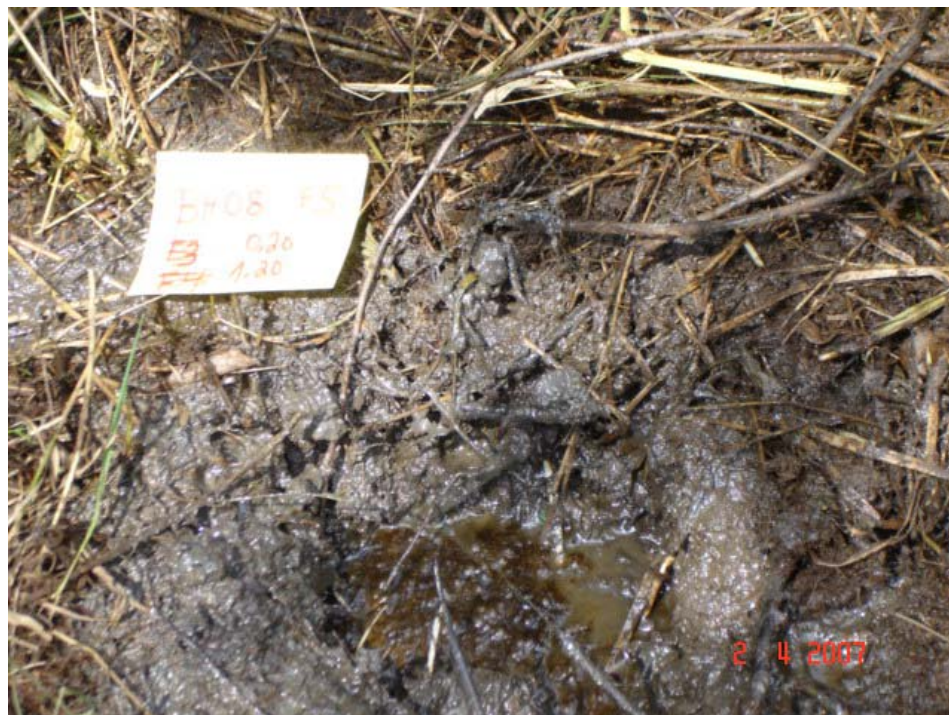
Figura 22. Ocorrência de filme de óleo em fase livre no Furo 5 perfurado no entorno do poço BH-08.
