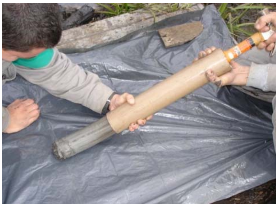
Figura 18. Amostra argilosa sendo retirada do cano por pressão manual.
