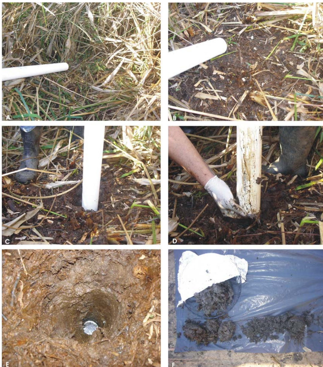
Figura 23. (A) local escolhido para cravar o cano, (B) a superfície do local é limpa, (C) cano sendo cravado, (D) o cano sendo retirado cuidando sempre para não perder a amostra, (E) o buraco com água após a retirada do cano, (F) tigela com amostra tapada com papel alumínio.
