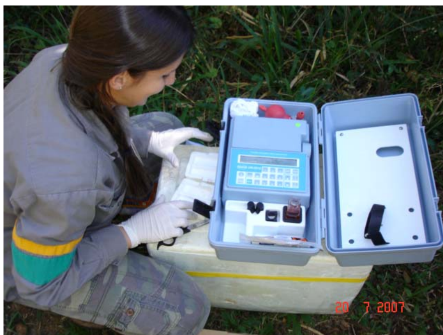
Figura 11. Parâmetros de atenuação natural analisados em Espectrofotômetro HACH DR/2010
