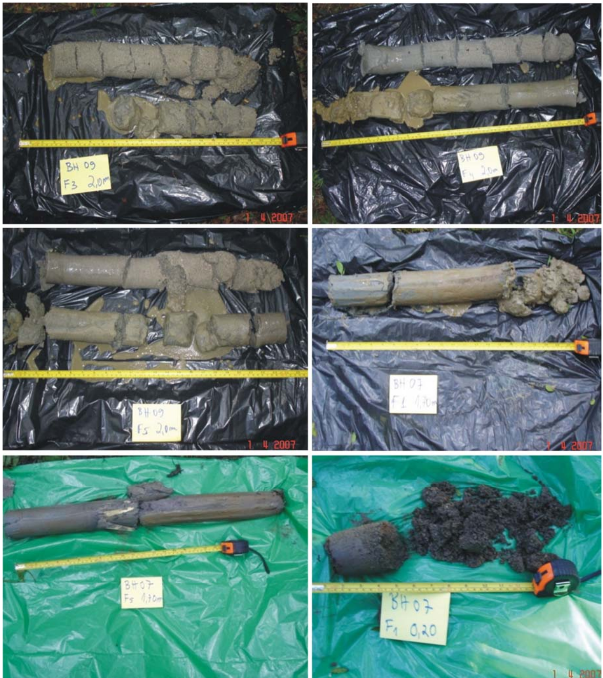
Figura 14. Fotografias de testemunhos de solo coletados no entorno dos poços multi-níveis BH-7 e BH-9.
