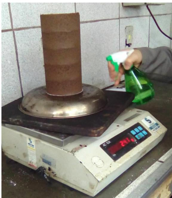
Figura 30: Corpo de prova em processo de umedecimento
