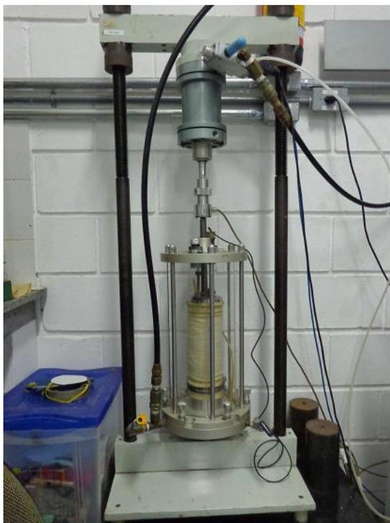
Figura 29: Equipamento triaxial de cargas repetidas - LAPAV/UFRGS
