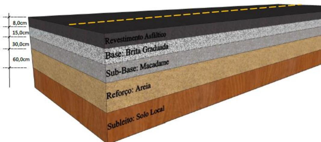
Figura 13: Estrutura típica do pavimento dos trechos experimentais da BR-290/RS (Bock, 2016)
