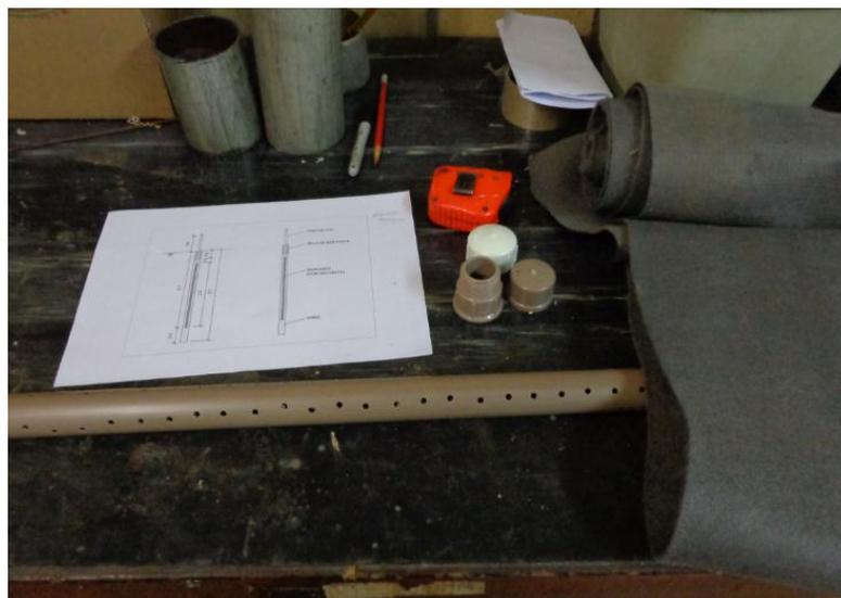
Figura 23: Materiais utilizados para confeccionar o medidor de NA
