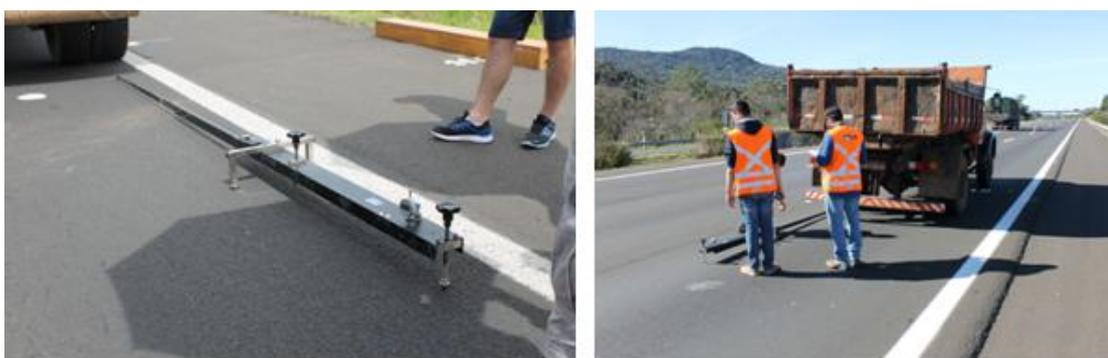
Figura 15: Avaliação estrutural dos trechos monitorados com Viga Benkelman
