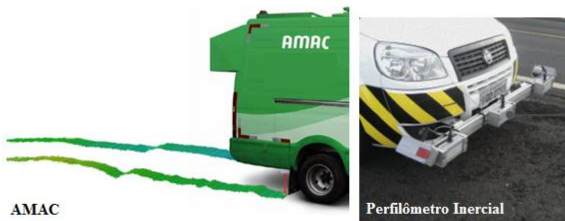
Figura 17: Equipamentos que realizam medições de irregularidade
